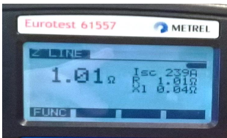
Sl. 5.7. Rezultat mjerenja impedancije petlje jednofazne utičnice 2
