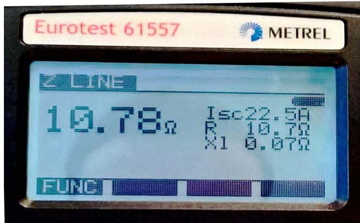
Sl. 5.5. Rezultat mjerenja impedancije petlje trofazne utičnice (pogreška uključena)
