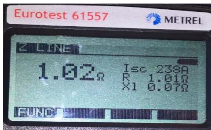
Sl. 5.4. Rezultat mjerenja impedancije petlje trofazne utičnice
