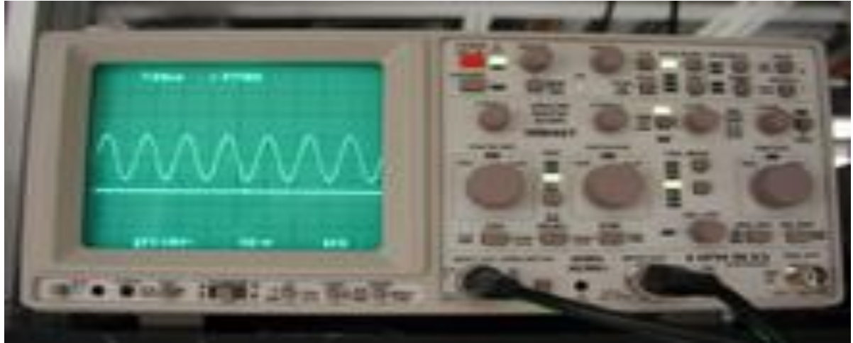
Sl.3.1. Prikaz sinusnog napona na zaslonu osciloskopa[9]
