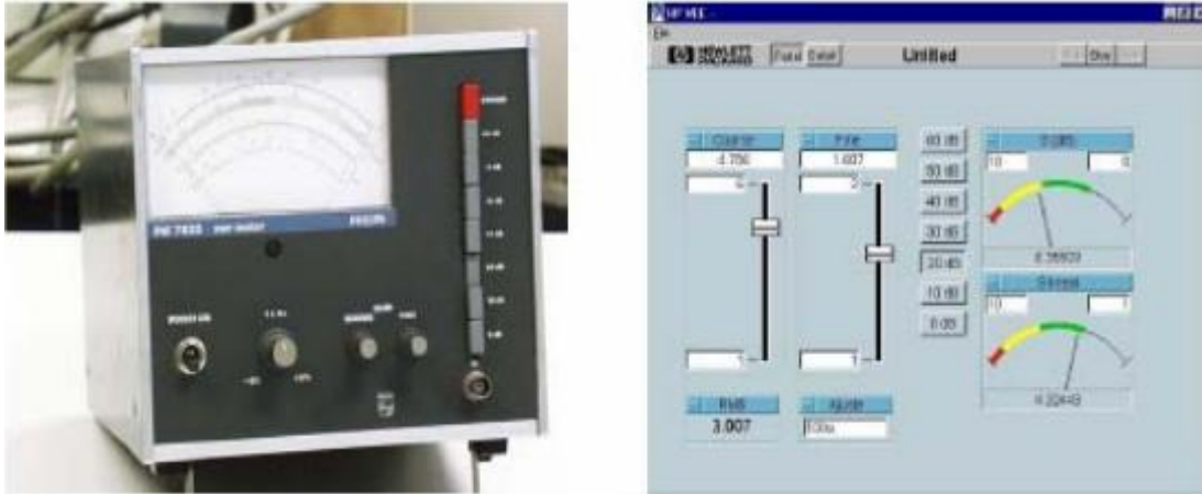
SI.2.2. Prikaz klasičnog i virtualnog instrumenta[1]
