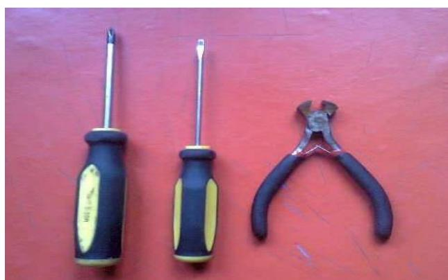
**Slika 3.1. Alat potreban za rastavljanje uređaja**
