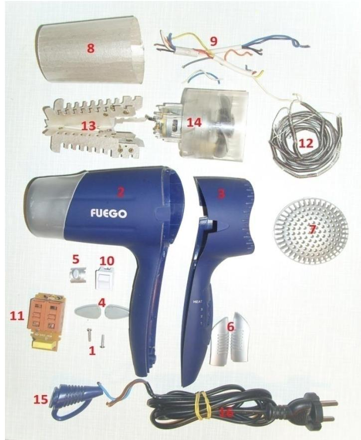
**Slika 3.5. Svi dijelovi sušila za kosu**
