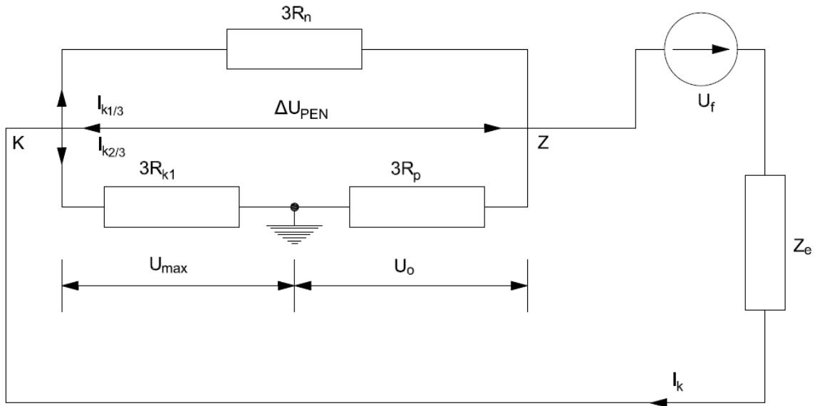
**Slika 4.4.** Shema referentne faze za izračun struje JKS [3]
