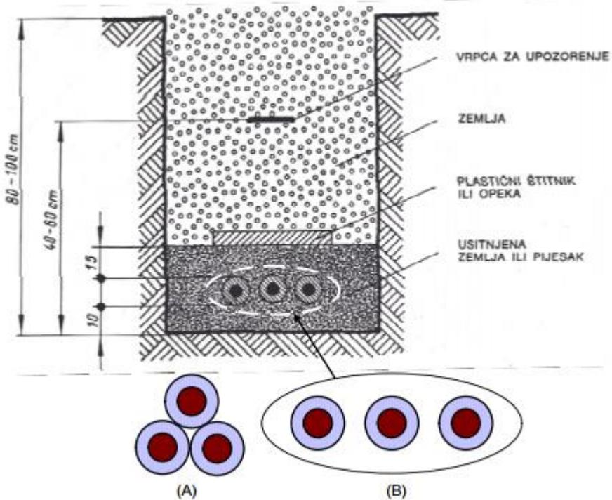
**Slika 3.7.** Kabelski rov [2]
