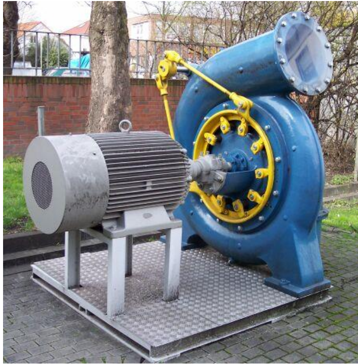
Slika 3.8. Francisova turbina manje snage, [15]
