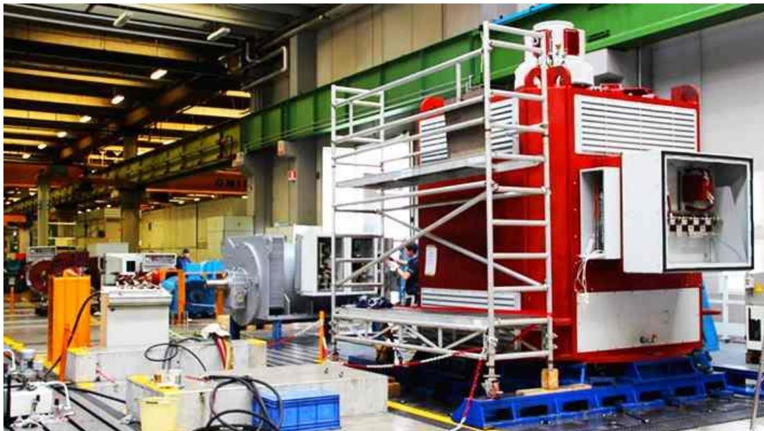
**Slika 4.6. Tvorničko ispitivanje hidrogeneratora, [25]**
