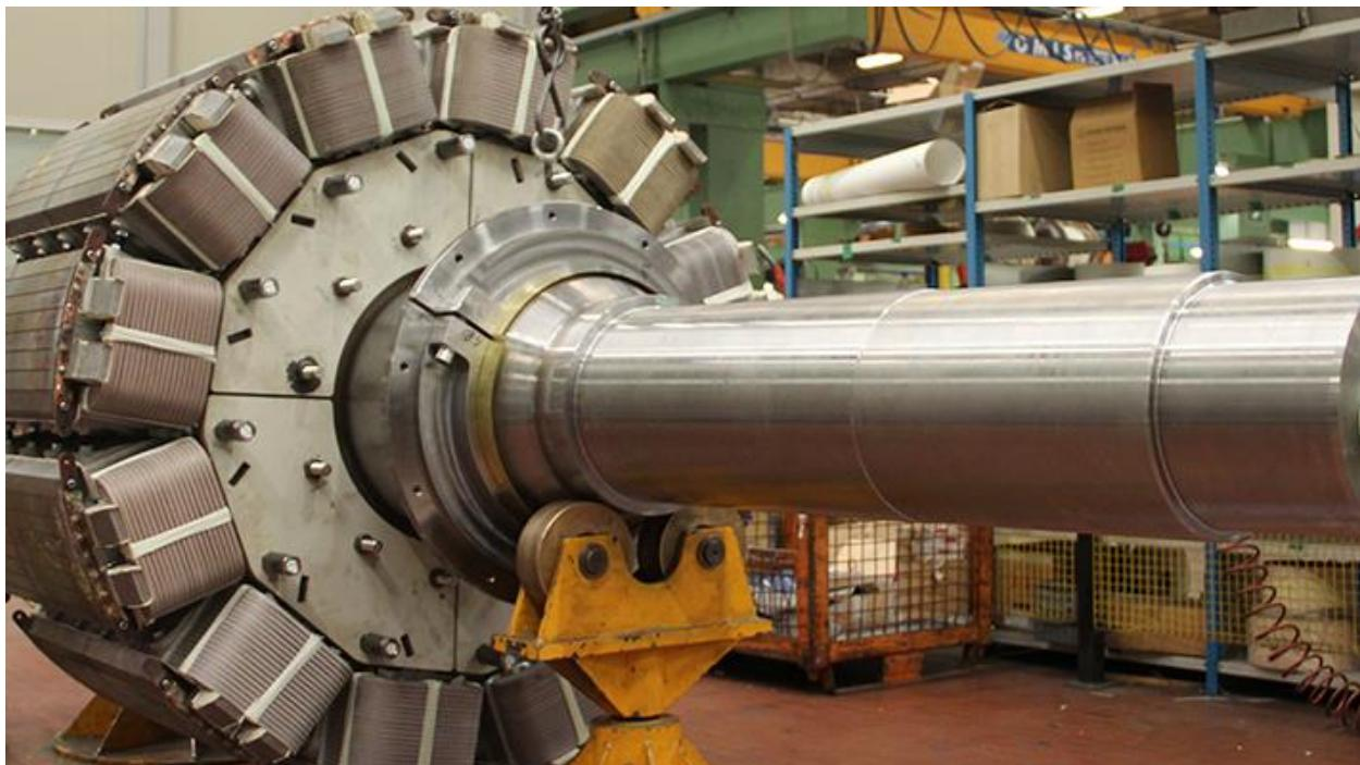
**Slika 4.2.** Rotor hidrogeneratora, [25]
