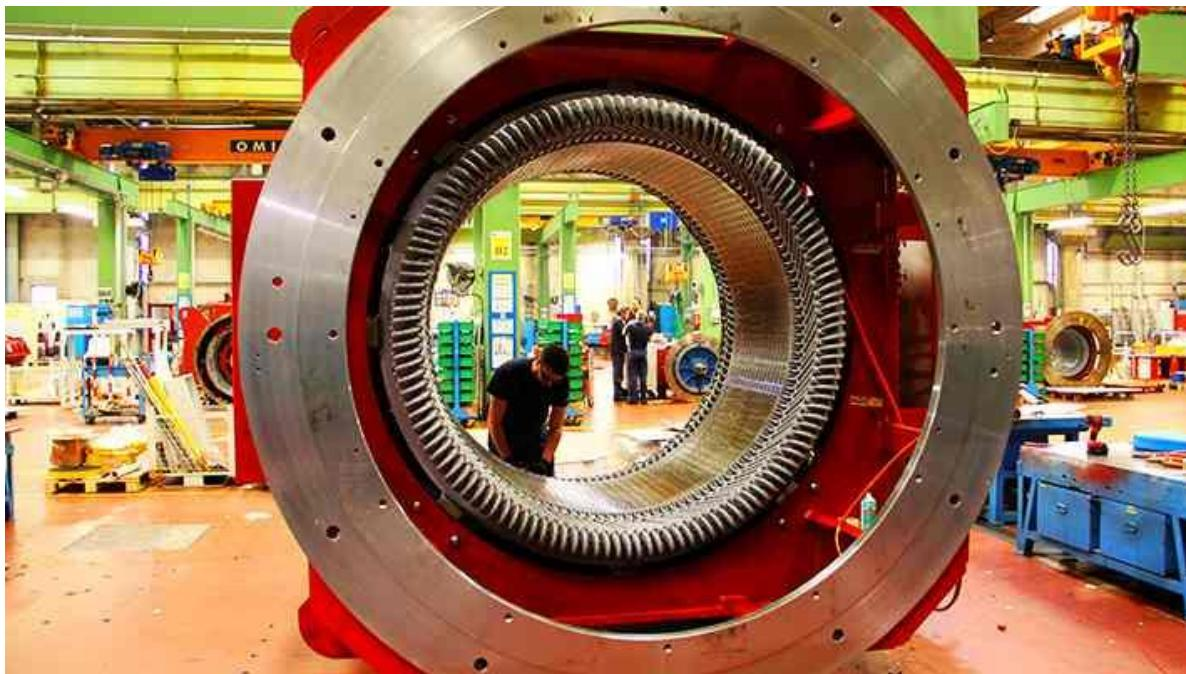
**Slika 4.3. Stator hidrogeneratora, [25]**
