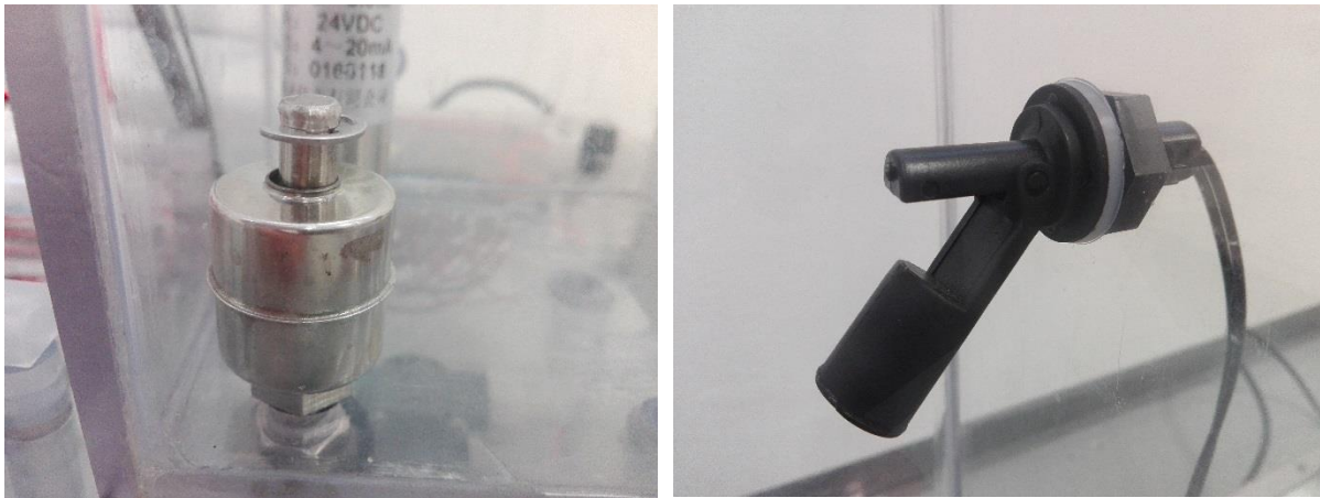
Slika 2.2. Izgled krajnjih senzora razine postavljenih na spremnike
