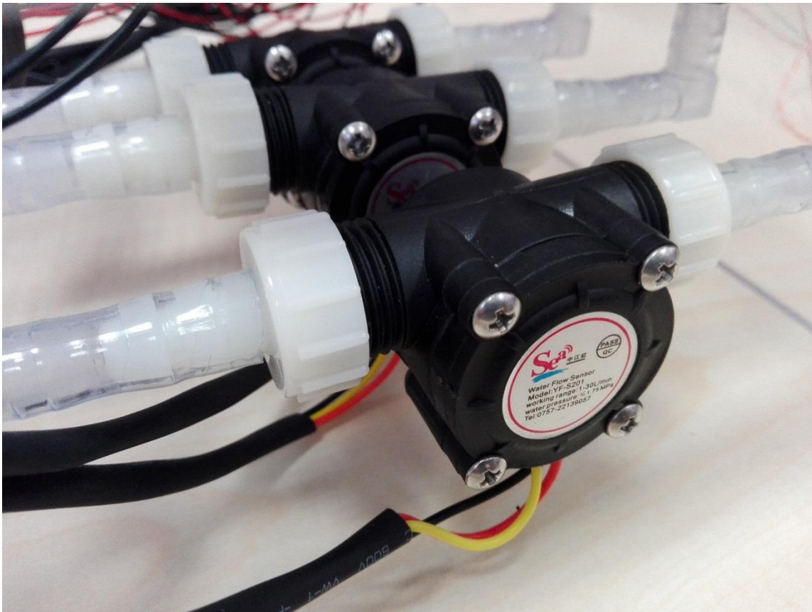
Slika 2.4. Mjerač protoka YF-S201
