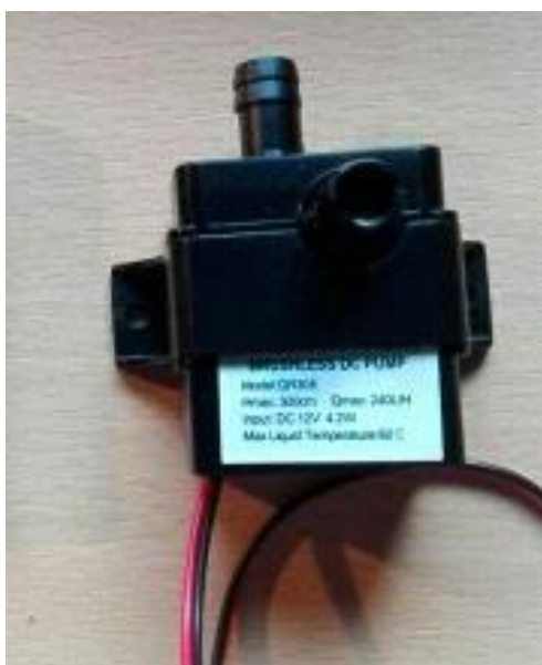
Slika 2.5. Crpka korištene pri izradi makete
