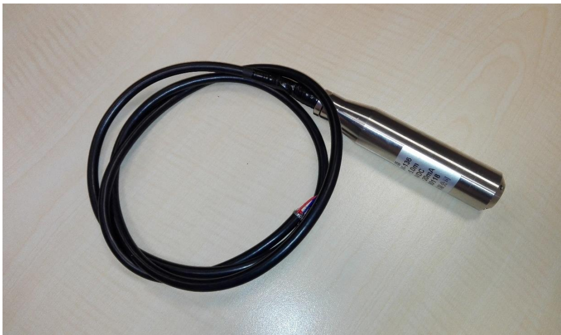
Slika 2.3. Analogni senzora razine
