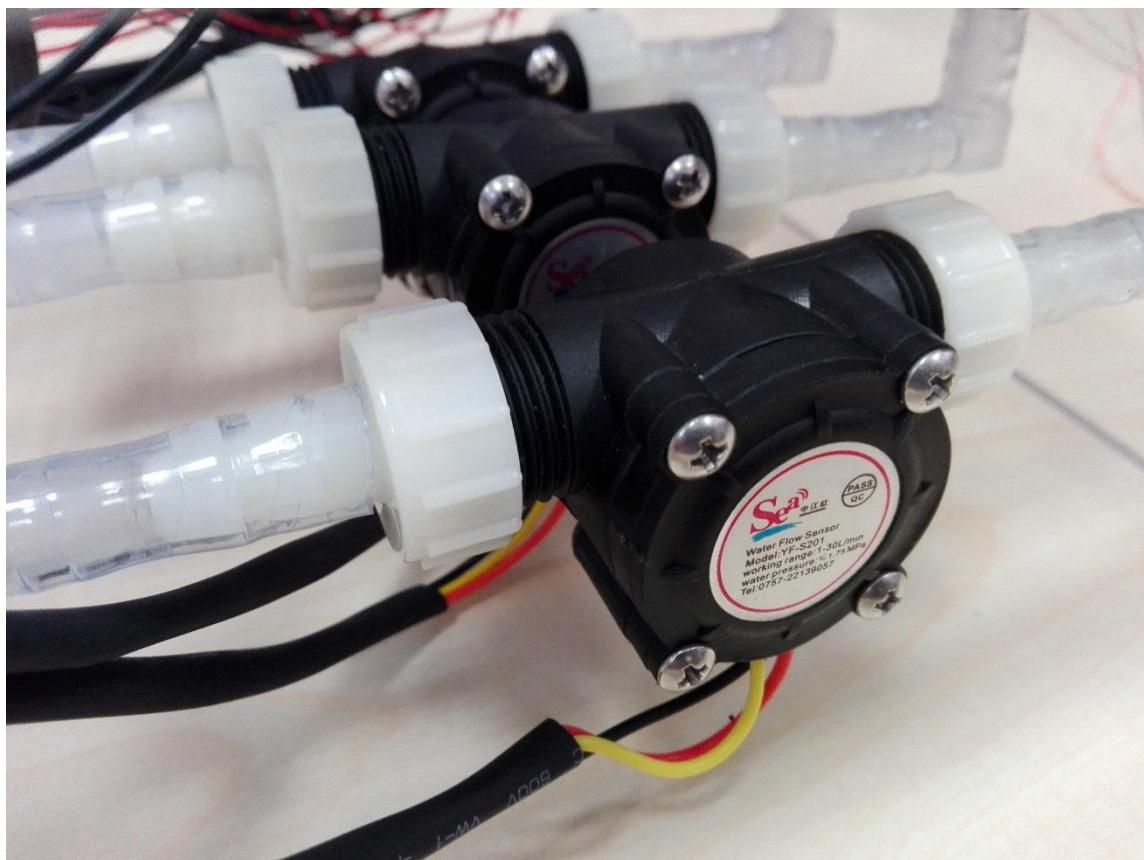
Slika 2.4. Mjerač protoka YF-S201
