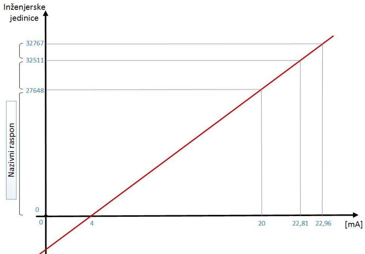
Slika 3.4. Ovisnost digitaliziranog signala o strujnom signalu 4...20 mA
