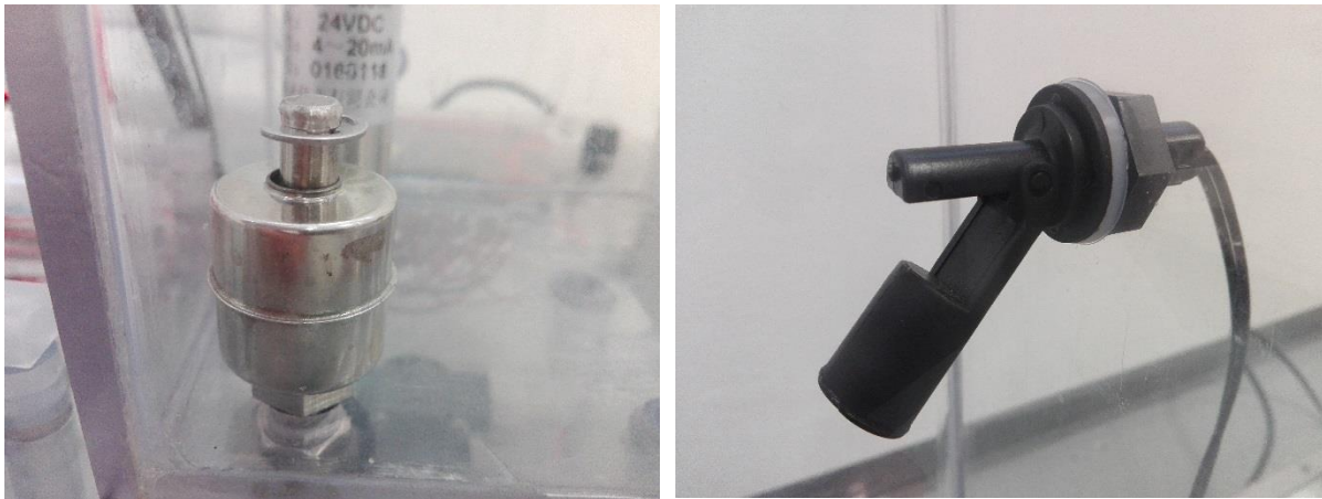
Slika 2.2. Izgled krajnjih senzora razine postavljenih na spremnike
