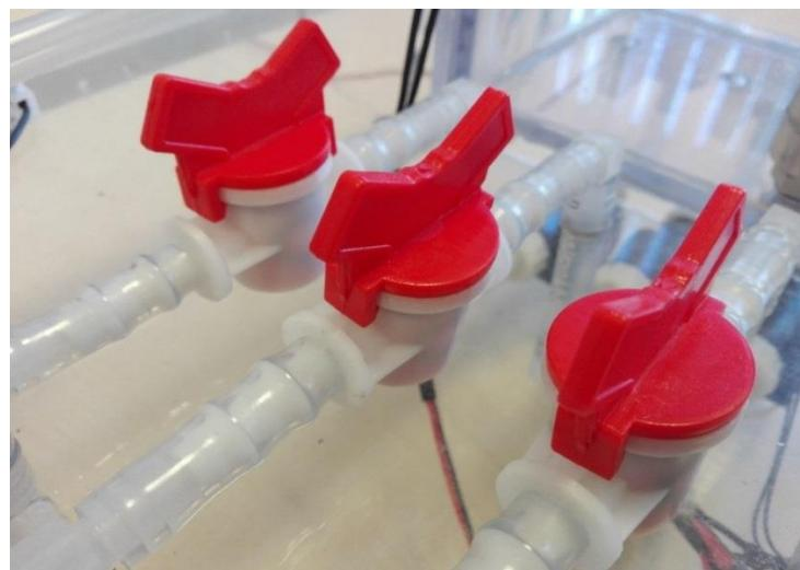
Slika 2.12. Ručno upravljni ventili za simulaciju poremećaja
