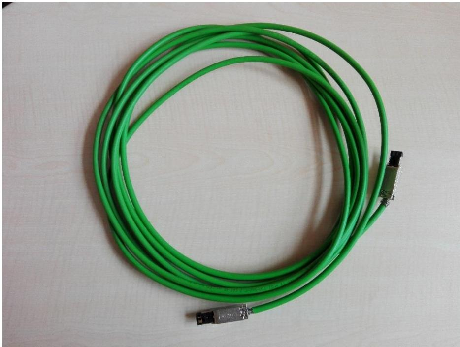
Slika 3.6. Kabel korišten za povezivanje uređaja putem PROFINET-a
