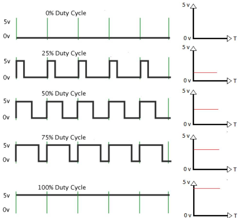
Slika 2.8. Valni oblice pulsno-širinski moduliranog signala [4]
