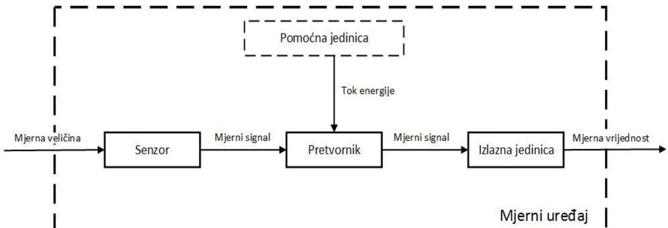
Slika 2.1. Pojednostavljeni blokovski prikaz mernog uređaja [2]
