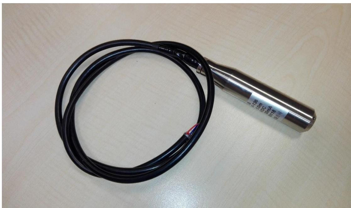
Slika 2.3. Analogni senzor razine
