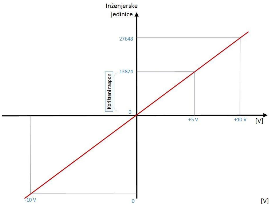
Slika 3.5. Ovisnost digitaliziranog signala o naponskom signalu -10...+10 V
