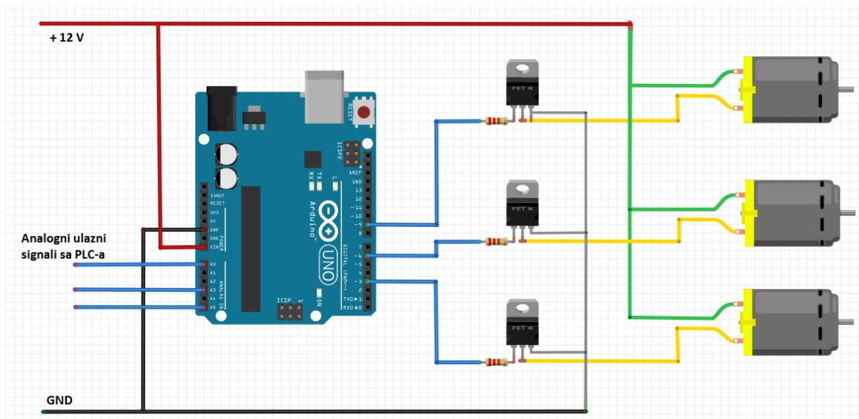
Slika 2.7 Način spajanja mikroupravljača, tranzistora i motora
