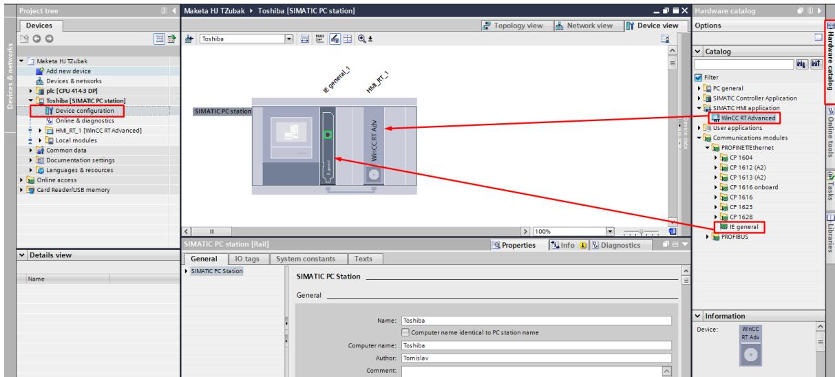
Slika 4.4. Dodavanje modula uređaju za HMI sučelje
