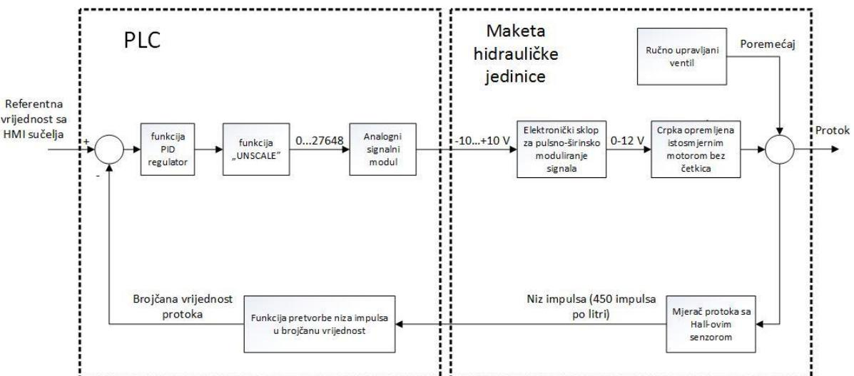
Slika 2.13. Struktura regulacijskog kruga makete hidrauličke jedinice
