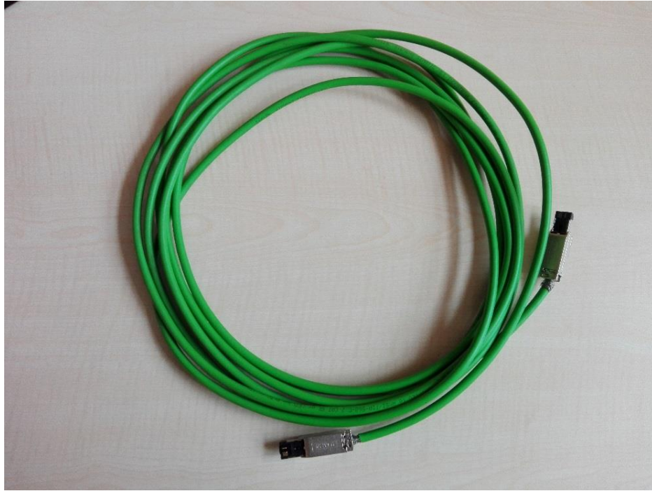
Slika 3.6. Kabel korišten za povezivanje uređaja putem PROFIBET-a
