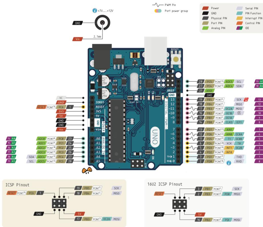
Slika 2.10. Raspored pinova mikroupravljača Arduino Uno [6]
