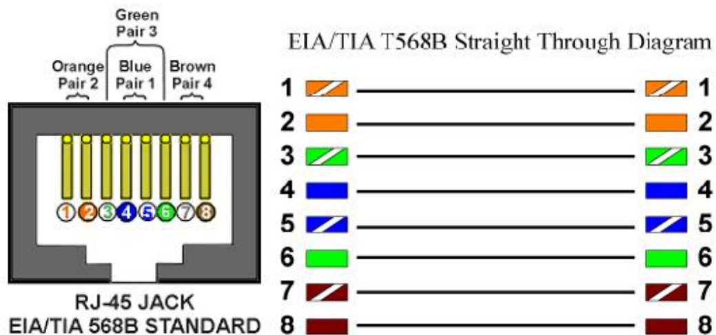
Sl. 2.3. Način spajanja parica Patch kabela [7].
