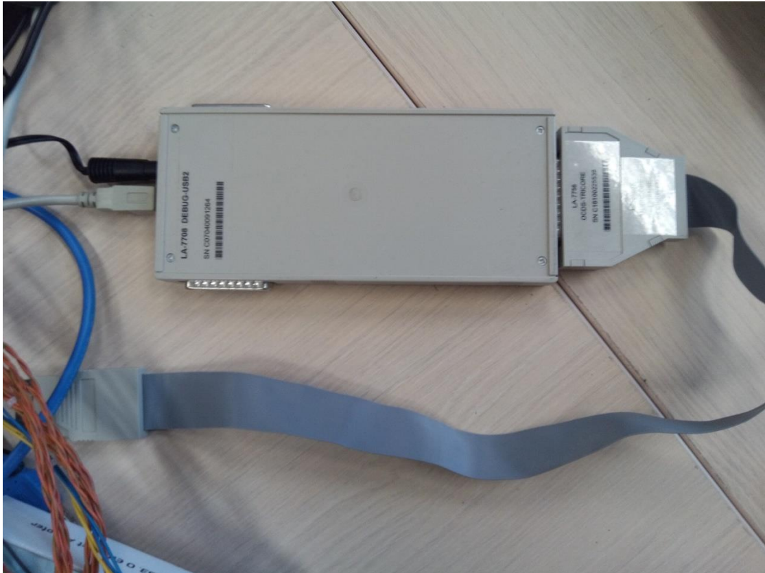
Sl. 3.5. Lauterbach uređaj za analizu pogrešaka
