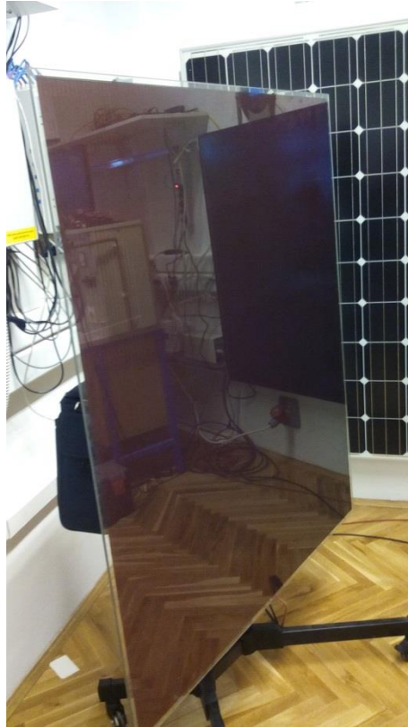
Slika 2.4. Prikaz modula bakar-indij-diselenida (CIS)
