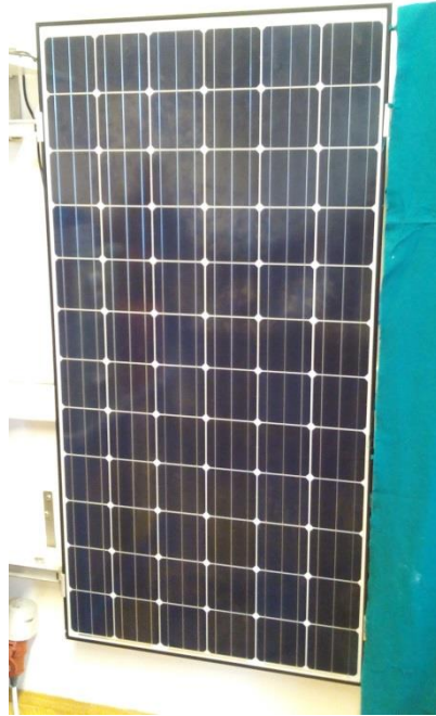
Slika 2.2. Prikaz monokristalnog FN modula
