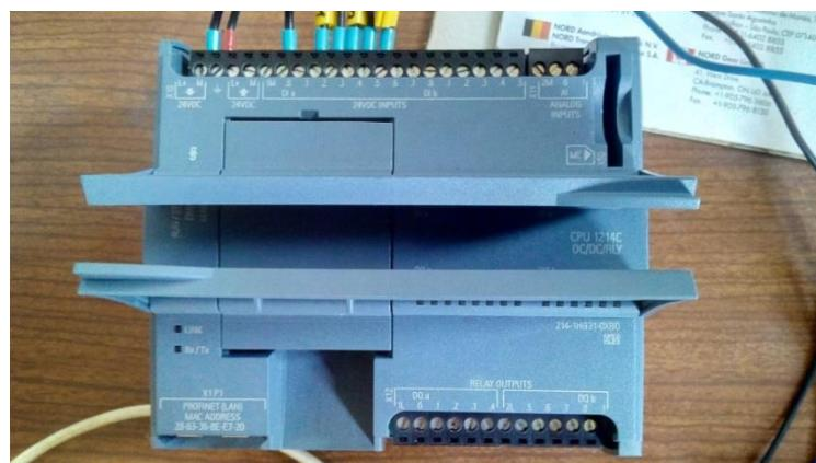
**Slika 6.1.** Siemens S7 1200 CPU
