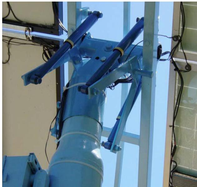
**Slika 3.2.** Glava Zomeworkovog pasivnog sustava za praćenje [9]
