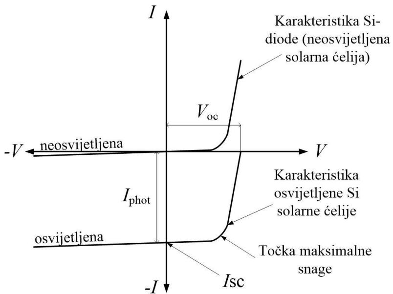
**Slika 2.7.** Strujno naponska karakteristika diode (neosvijetljene fotonaponske ćelije) i osvijetljene fotonaponske ćelije sa strujom kratkog spoja  $I_{\text{sc}}$  i naponom pravnog hoda  $V_{\text{oc}}$
