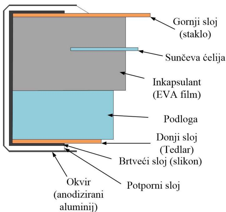
**Slika 3.1.** Poprečni presjek PV modula od kristalnog silicija
