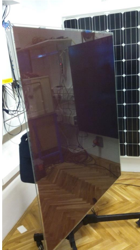
Slika 2.4. Prikaz modula bakar-indij-diselenida (CIS)
