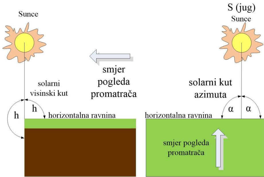
**Slika 4.7.** Solarni visinski kut i kut azimuta
