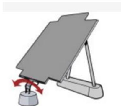
**Slika 3.5.** Izgled jednoosnog vertikalnog sustava za praćenje [12]
