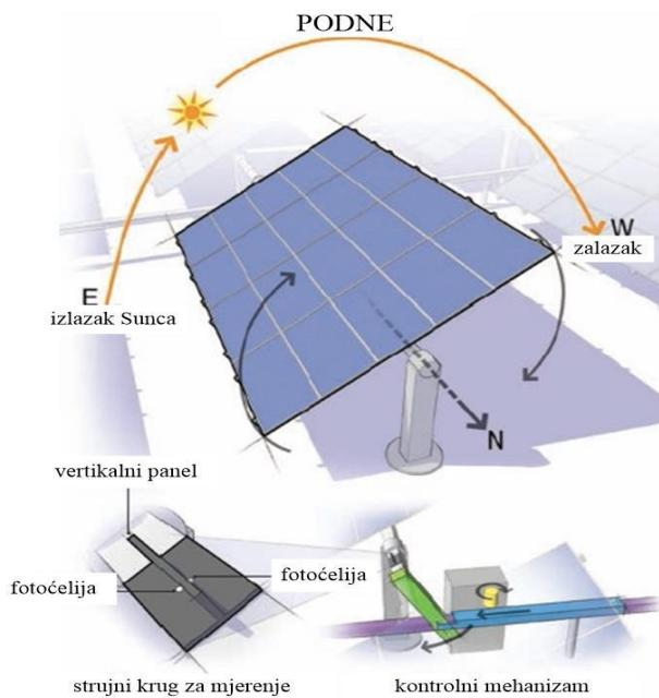
**Slika 3.4.** Izgled jednoosnog horizontalnog sustava za praćenje [11]
