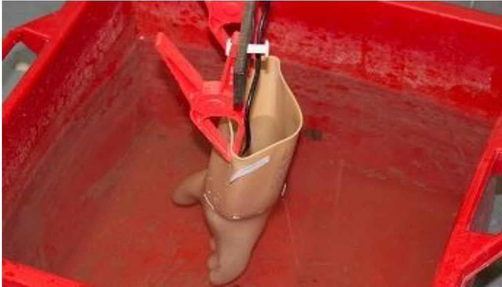
Slika 4.7. Laboratorijsko ispitivanje izolacijske rukavice [5]
