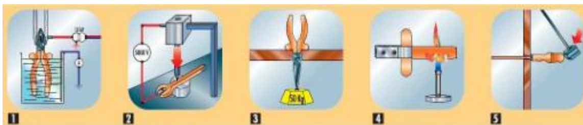
Slika 4.4. Vrste ispitivanja izoliranog alata za RPN tijekom proizvodnje [1]
