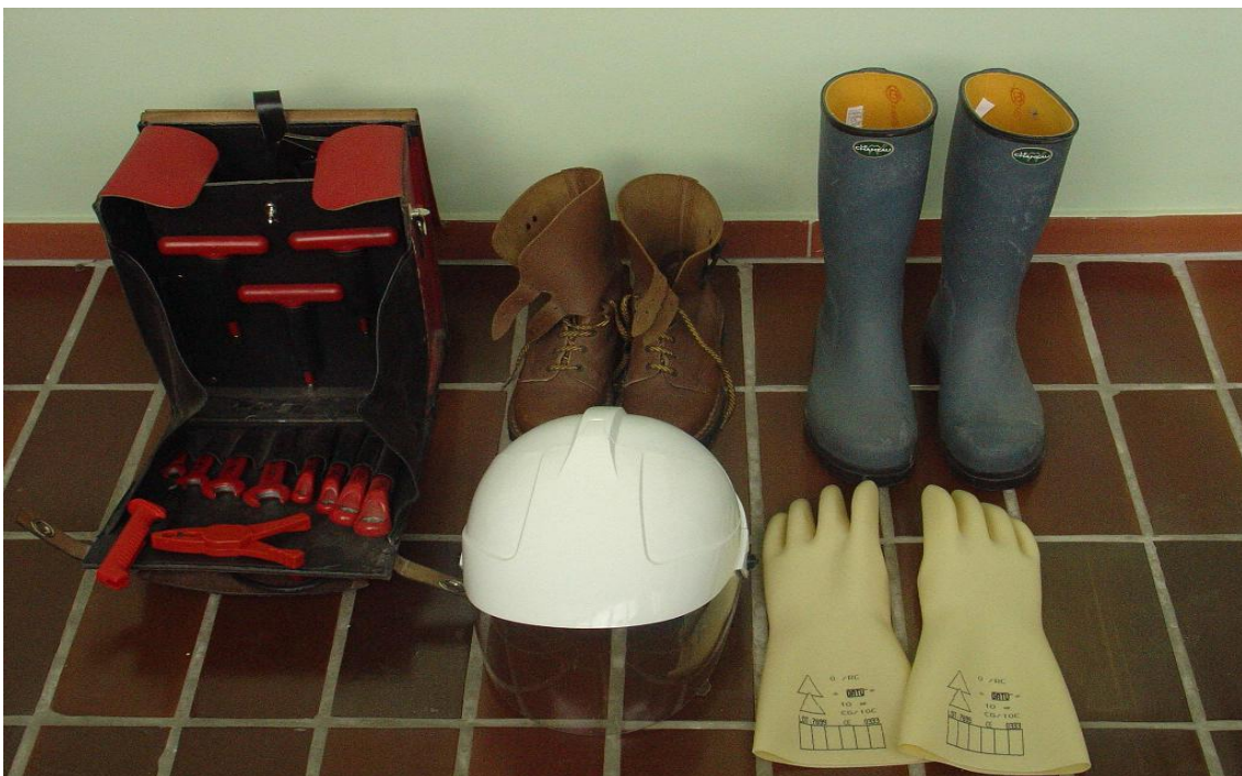
Slika 4.1. Zaštitna oprema i alat za rad pod naponom na niskom naponu
