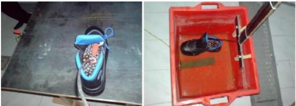
**Slika 4.8.** Laboratorijsko ispitivanje zaštitnih cipela [1]
