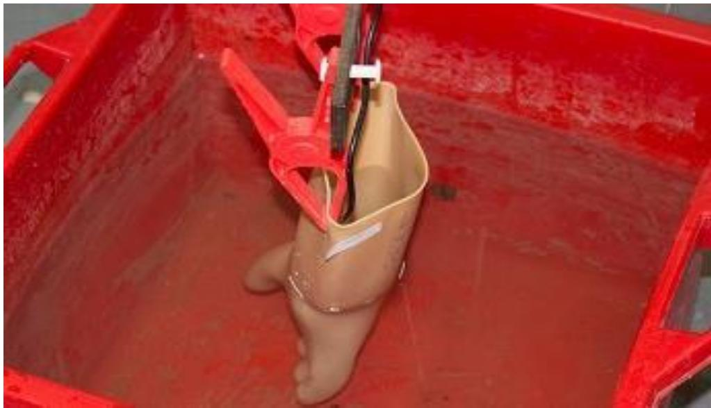
**Slika 4.7.** Laboratorijsko ispitivanje izolacijske rukavice [5]
