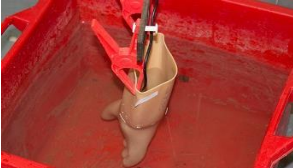
Slika 4.7. Laboratorijsko ispitivanje izolacijske rukavice [5]
