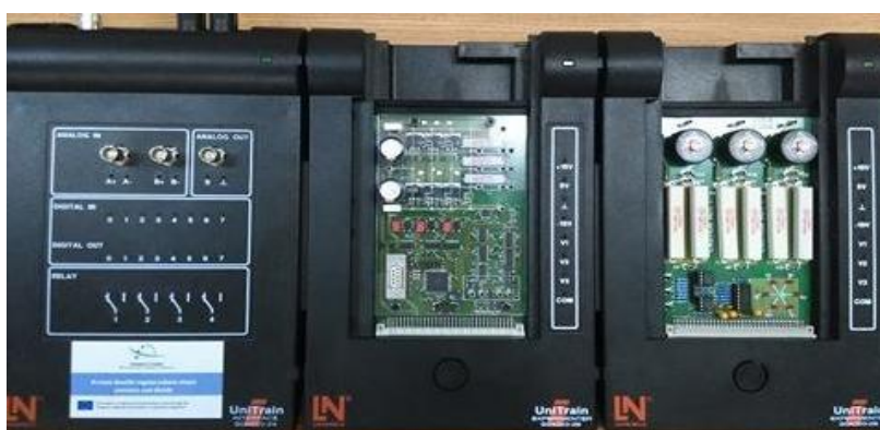
Slika 2.4. Sučelje sa eksperimentalnim karticama
