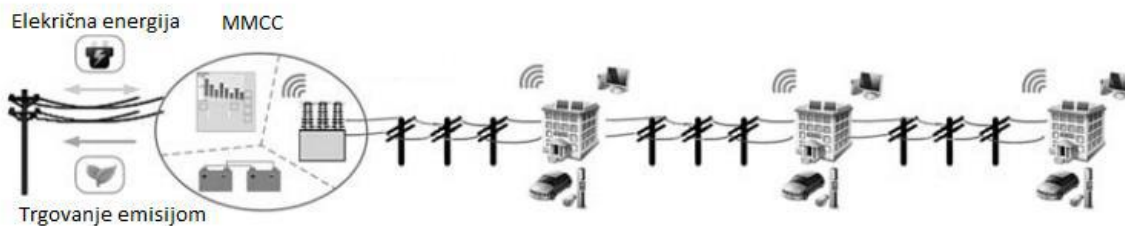
Slika 2.6. Mikromreža na razini niskonaponske mreže [8]
