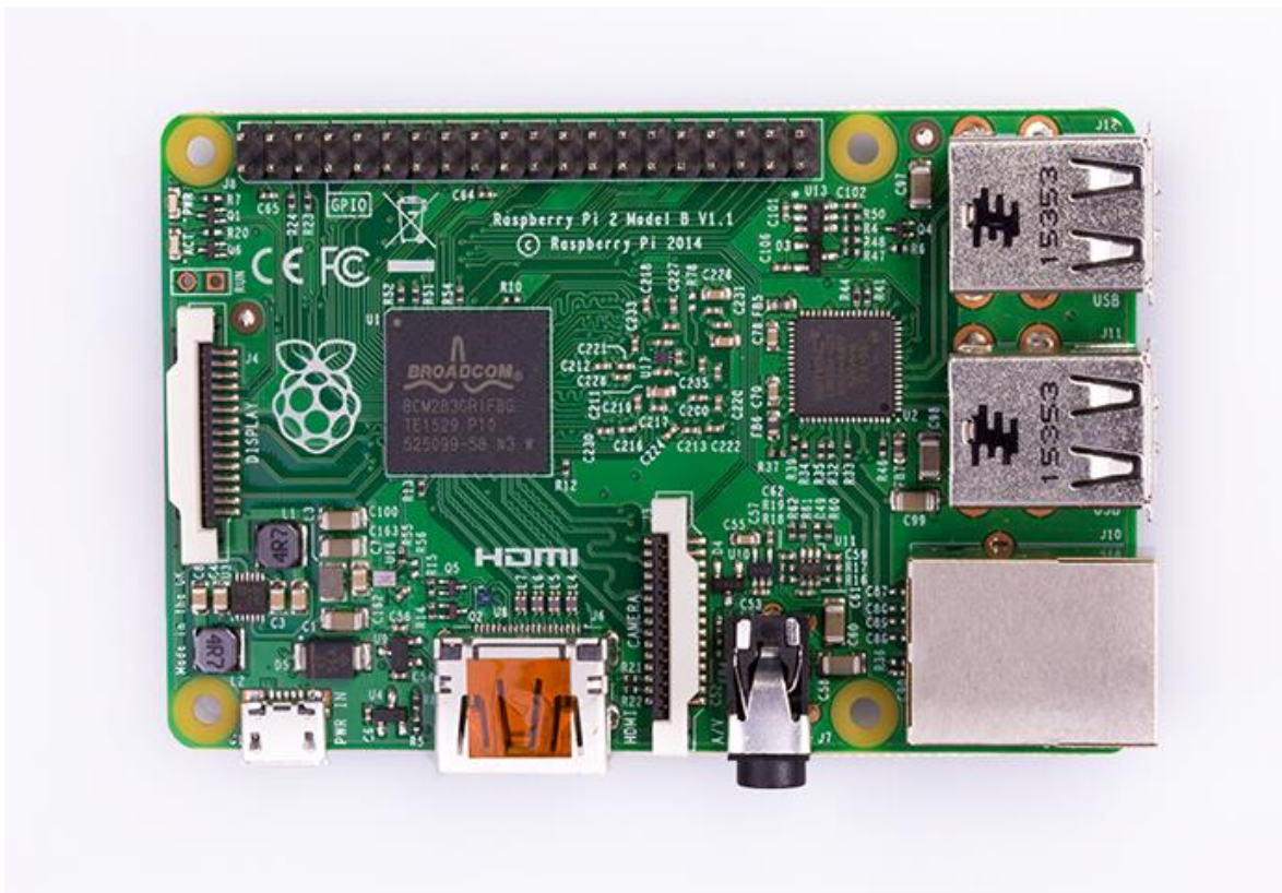
Sl. 3.1. Raspberry Pi 2 B razvojna platforma
