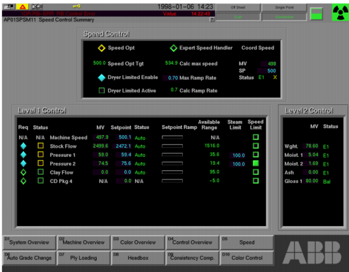
Slika 5.8. Prikaz kontrole brzine rada papirnog stroja 2 [16].
