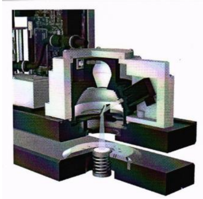
Slika 4.8. Prikaz strukture senzora boje [11].
