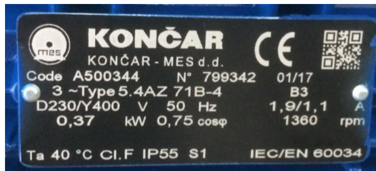
Sl. 4.14. Natpisna pločica izmjeničnog motora
