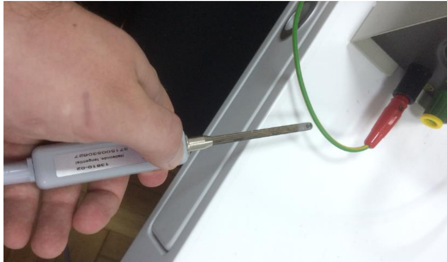
Sl. 4.19. Mjerenje magnetskog polja vodiča
