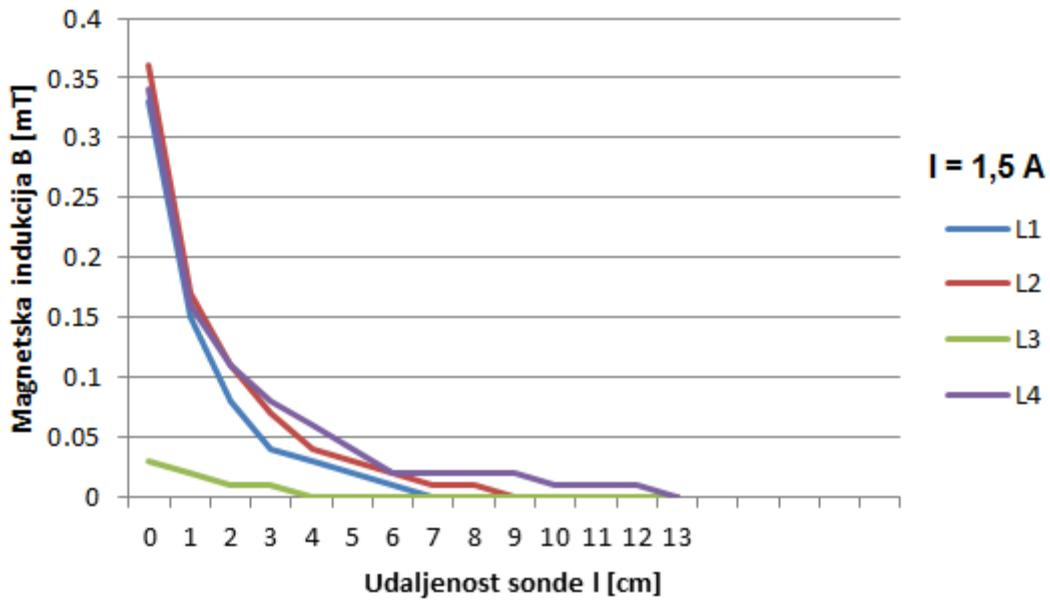
Sl. 4.12. Dijagram mjerena magnetskog polja oko zavojnica s željeznom jezgrom s obzirom na udaljenost sonde
