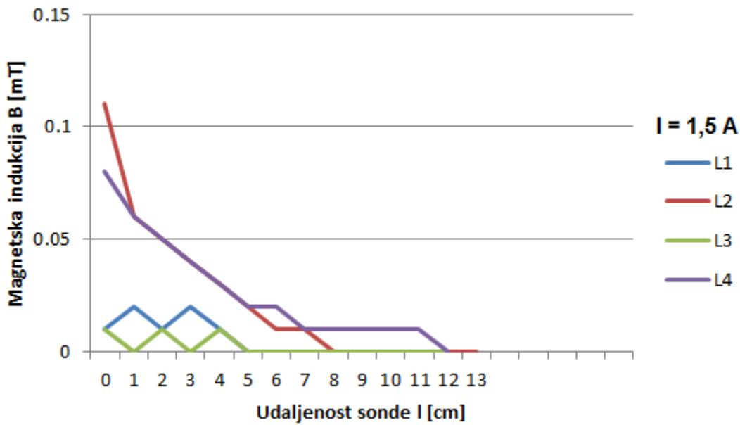
Sl. 4.10. Dijagram mjerena magnetskog polja oko zavojnica s obzirom na udaljenost sonde
