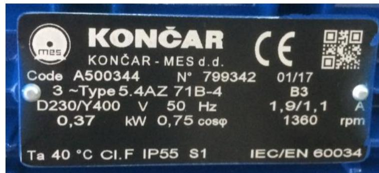
Sl. 4.14. Natpisna pločica izmjeničnog motora
