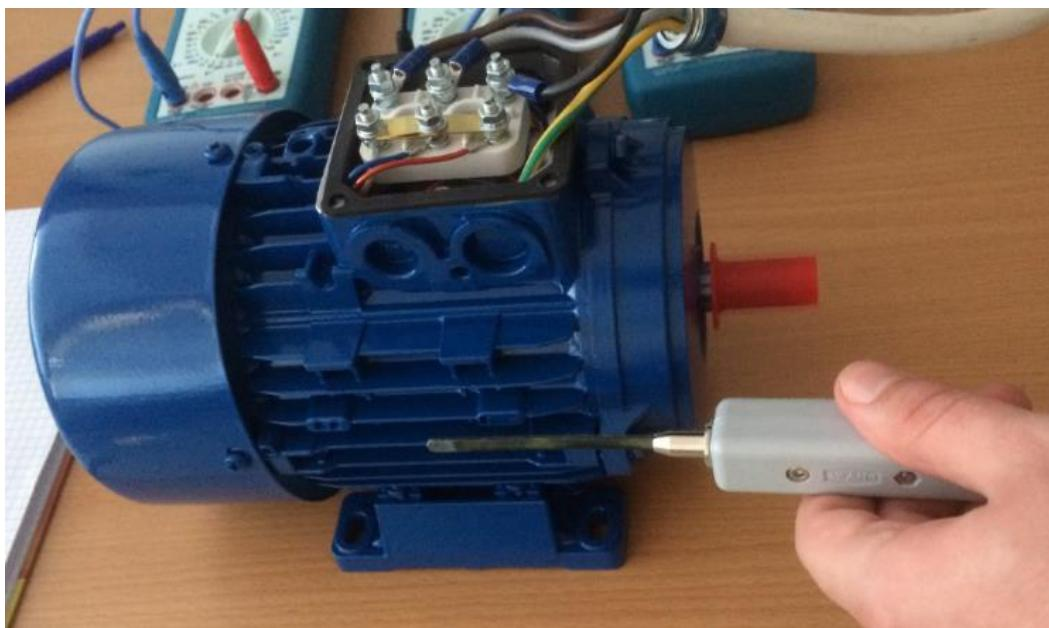
Sl. 4.15. Mjerjenje magnetske indukcije izmjeničnog motora
