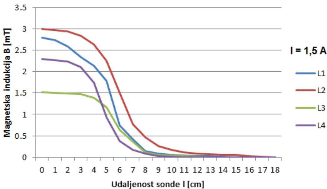
Sl. 4.9. Dijagram mjerenoj magnetskog polja unutar zavojnica s obzirom na udaljenost sonde
