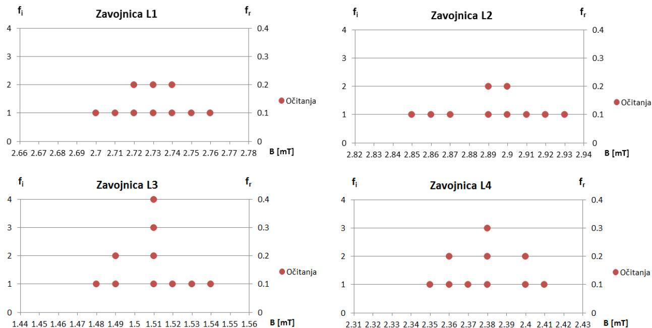
Sl. 4.8. Dijagrami očitanja mjerene magnetske indukcije zavojnica L1, L2, L3 i L4 pri izmjeničnoj struji
