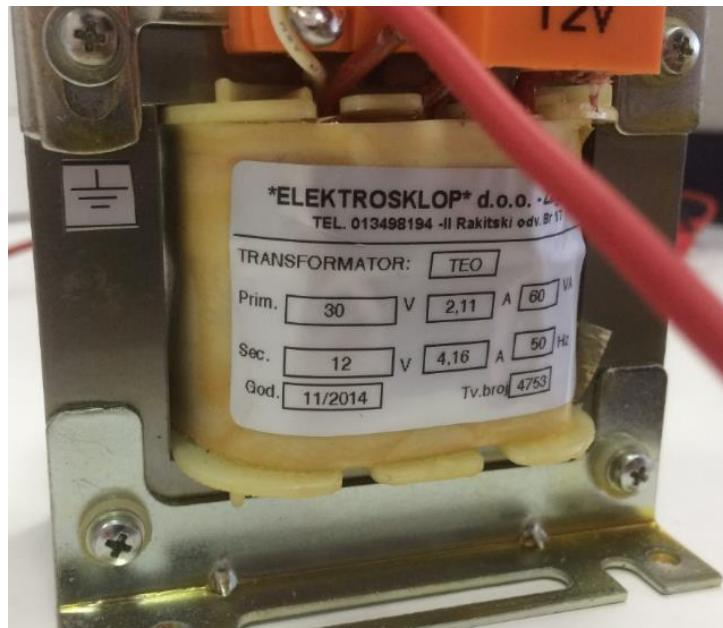
Sl. 4.13. Parametri transformatora
