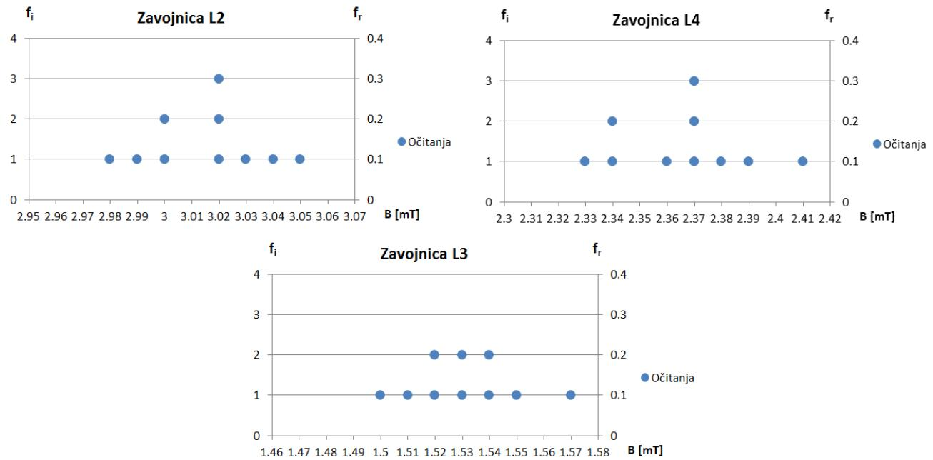
Sl. 4.7. Dijagrami očitanja mjerene magnetske indukcije zavojnica L2, L3 i L4 pri istosmjernoj struji
