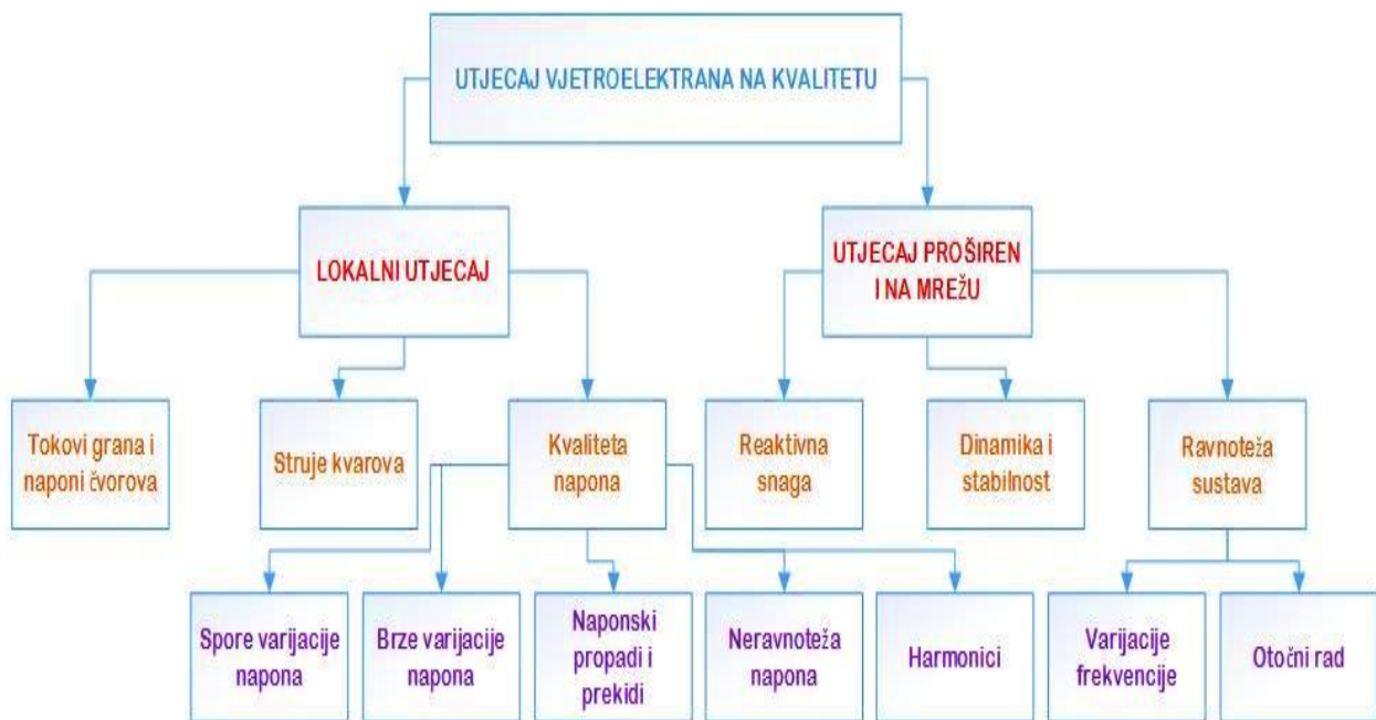
Slika 4.9. Problemi uzrokovani proizvodnjom iz vjetroelektrane [12]
