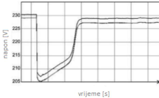
Slika 4.3. Naponski propad prilikom pokretanja velikog motora [11]
