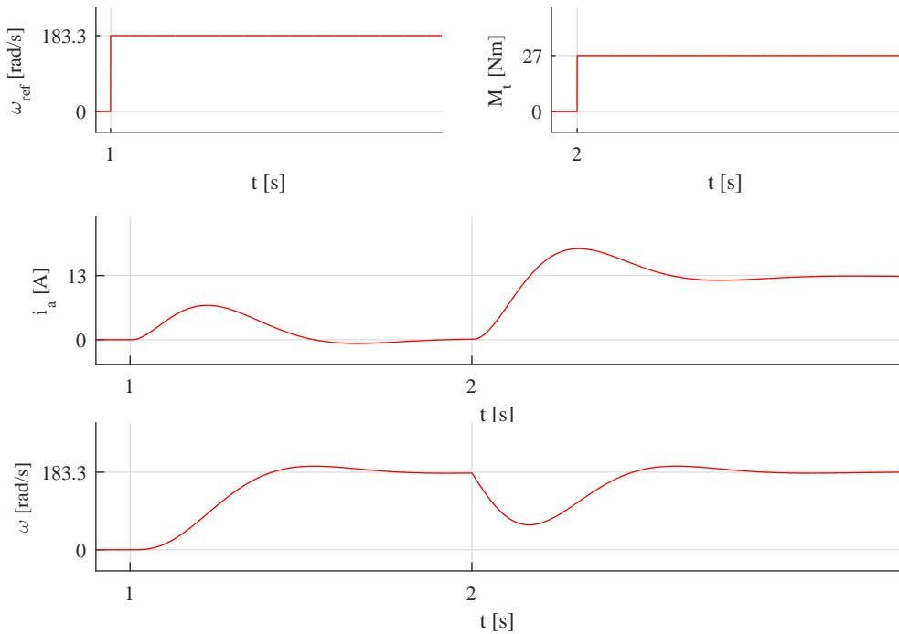
**Sl. 2.16:** Rezultati simulacije reguliranog istosmjernog motora
