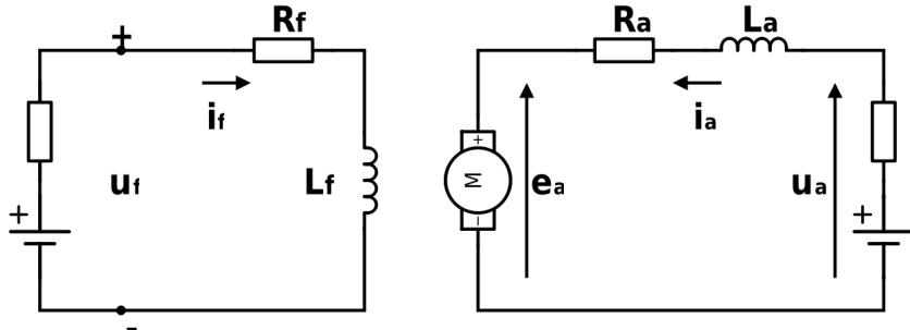
Sl. 2.2: Električna potpuna nadomjesna shema istosmjernog motora
