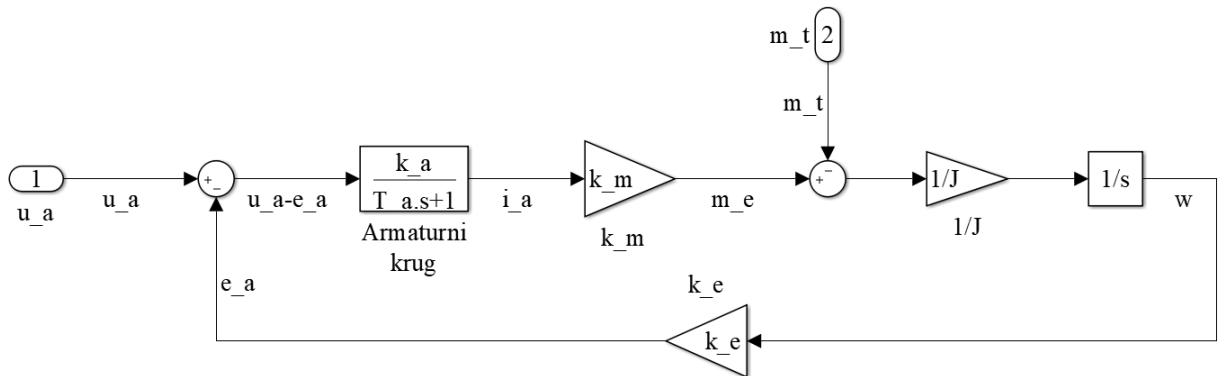
Sl. 2.4: Blok dijagram nereguliranog istosmjernog motora
