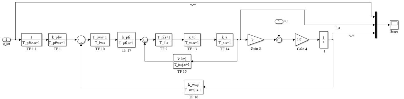
**Sl. 2.15:** Simulacijski model reguliranog istosmjernog motora
