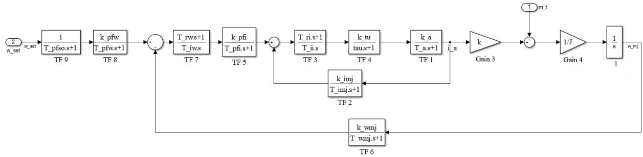
**Sl. 2.14:** Strukturalna shema regulacije istosmjernog motora
