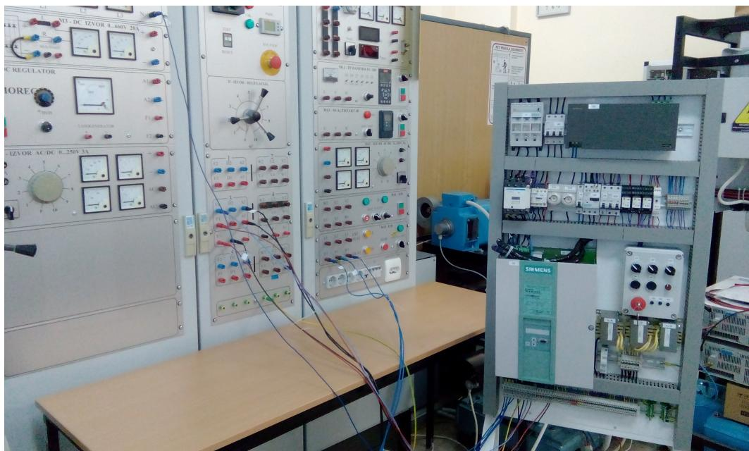
Sl. P6.2: Simoreg priključen na panel sa izvedenim kontaktima reguliranog motora
