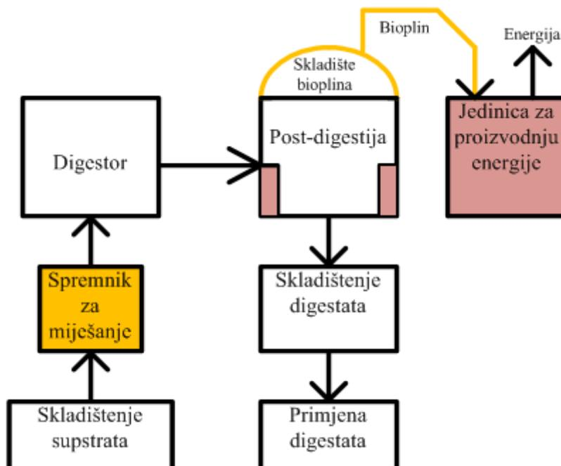
Slika 2.17. Proces nastajanja energije iz bioplinskog postrojenja
