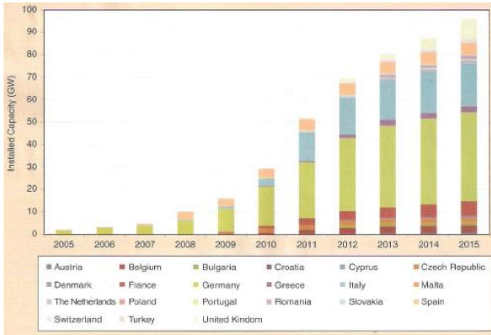
**Slika 2.14.** Kumulativni instalirani kapacitet europskih fotonaponskih sustava [6]
