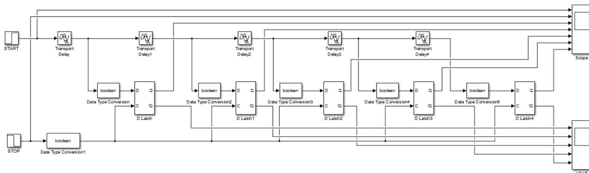
Sl. 4.1. Shema vremensko-digitalnog pretvornika realizirana u Simulink-u
