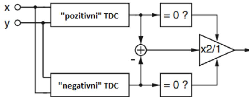
Sl. 3.5. Bipolarni TDC s ispravkom zbog nelinearnosti [1]
