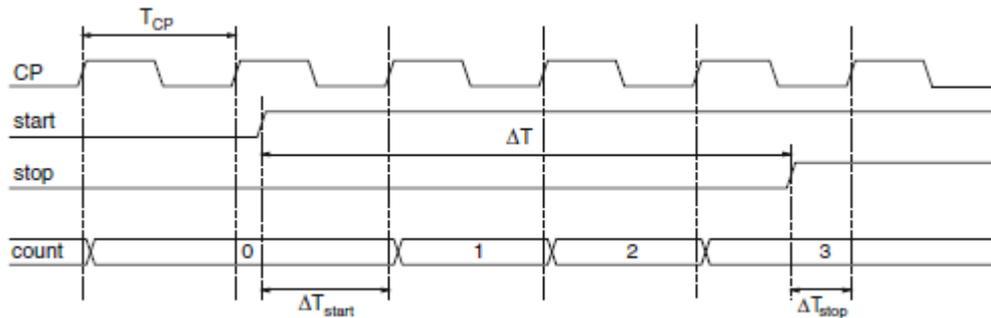
Sl. 2.2. Princip rada TDC-a temeljenog na brojaču [1]
