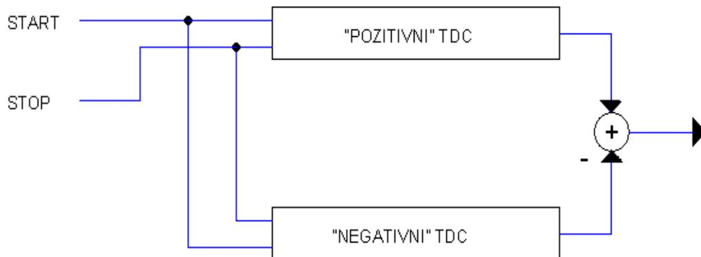
**Sl. 3.3.** Osnovni bipolarni TDC
