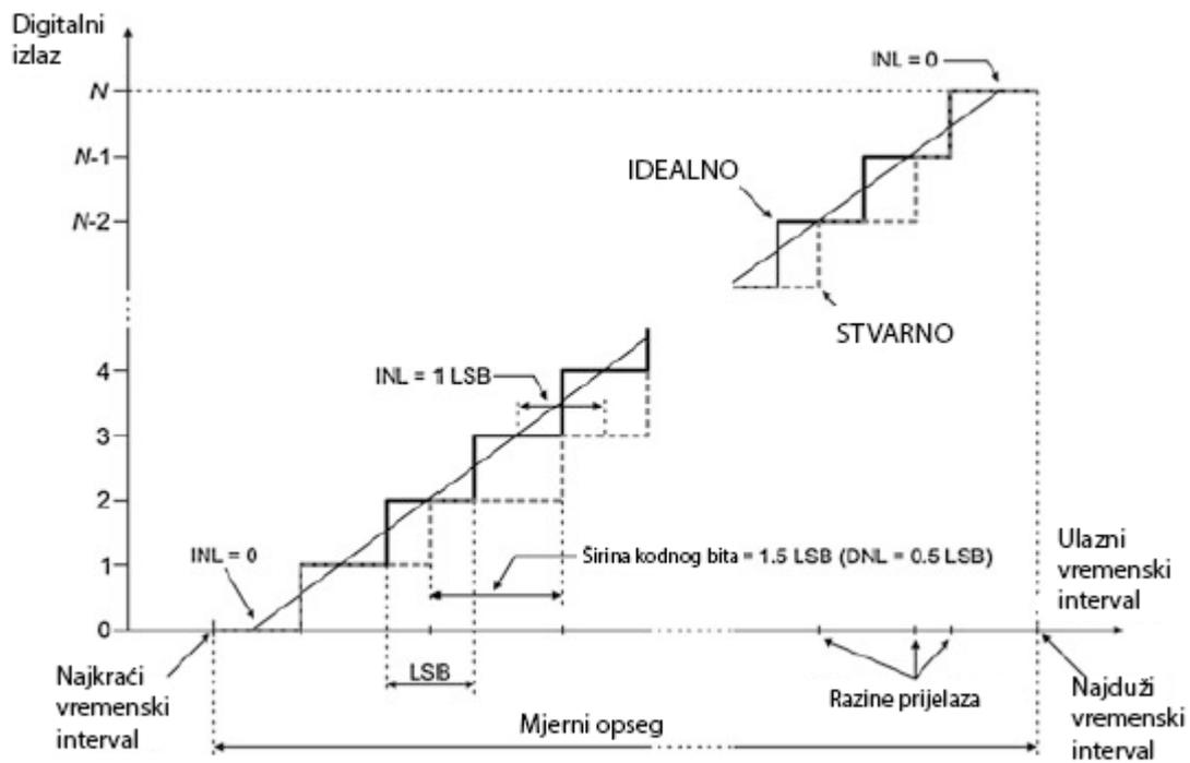
Sl. 2.4. Prijenosna karakteristika idealnog i realnog TDC-a [2]
