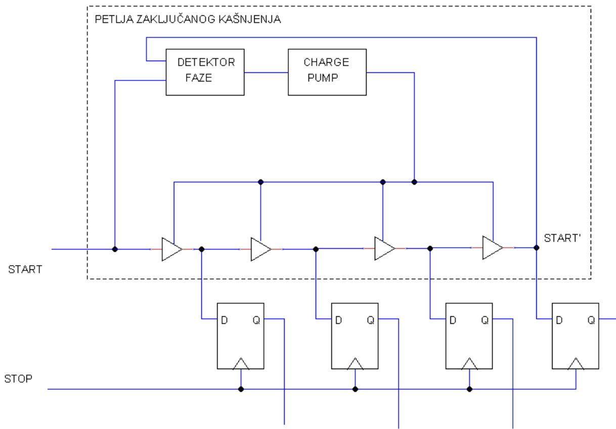
**Sl. 3.8.** *Vremensko-digitalni pretvornik s petljom zaključanog kašnjenja*
