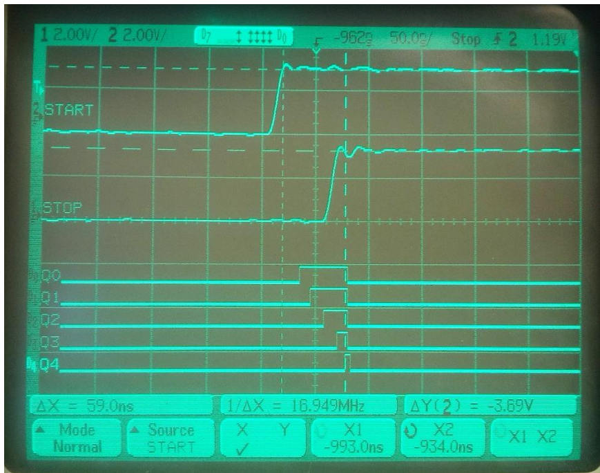
Sl. 5.3. Maksimalni vremenski period između START i STOP signala
