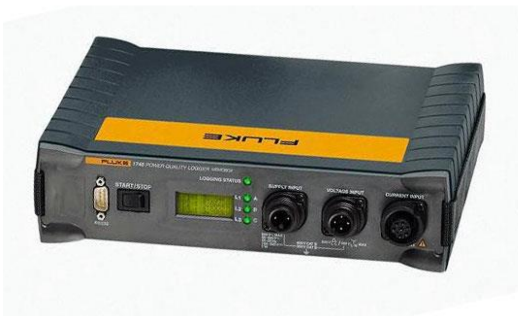
Slika 3.1.: Uređaj za mjerenje kvalitete električne energije FLUKE 1745 [11]
