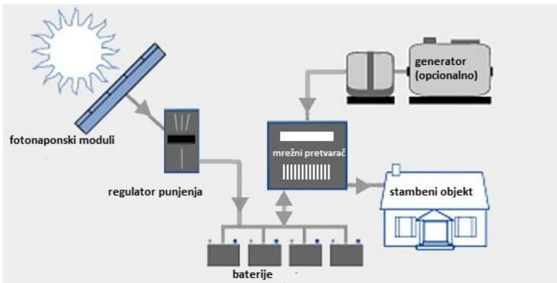
*Slika 2.8.: Samostalni fotonaponski sustav s pomoćnim generatorom [9]*
