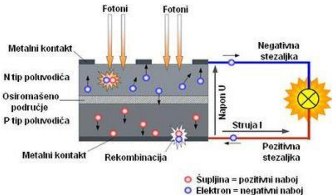
Slika 2.1.: Prikaz rada fotonaponske celije [2]
