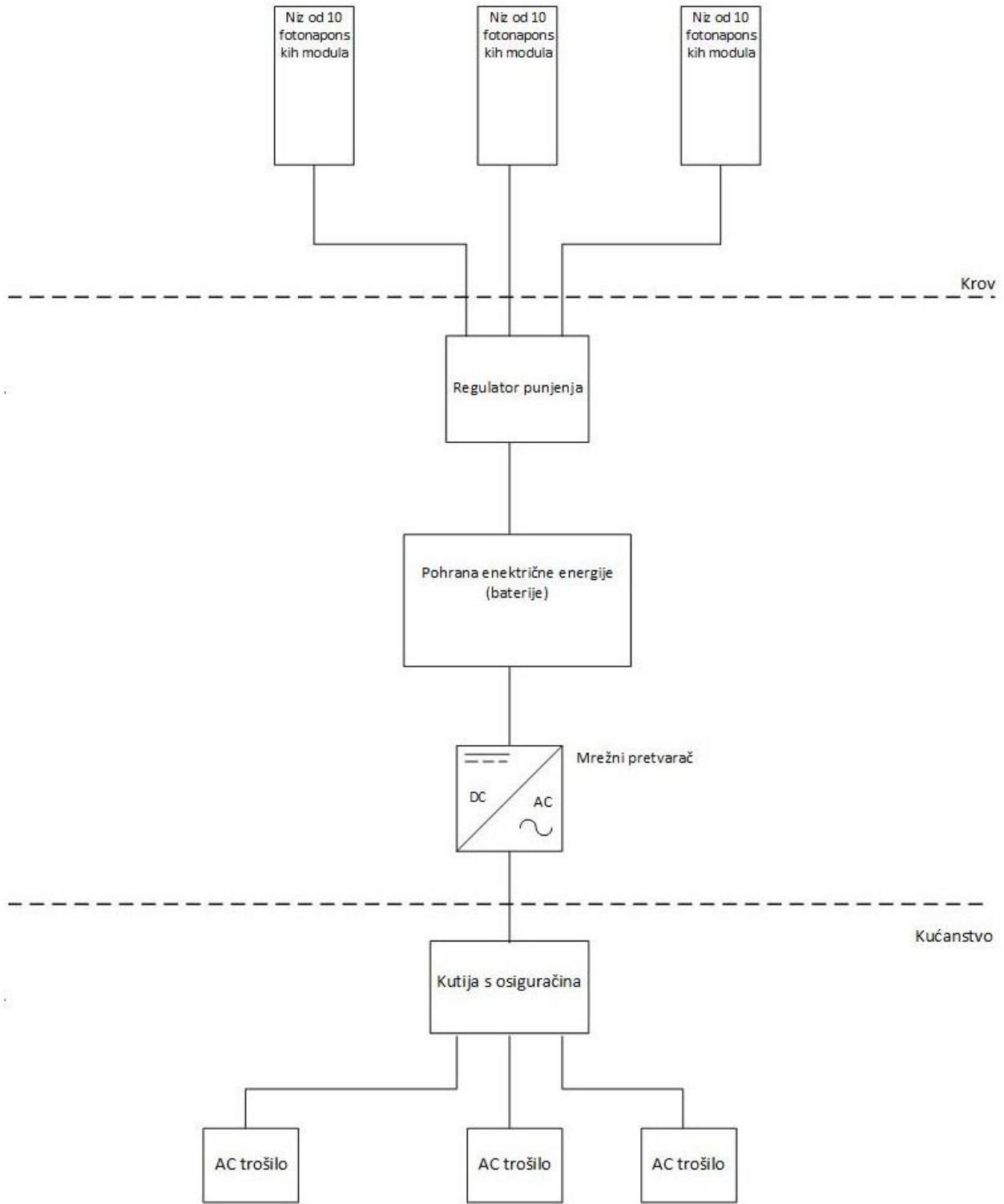
*Slika 4.7.: Shema samostalnog fotonaponskog sustava snage 7,84 kW*
