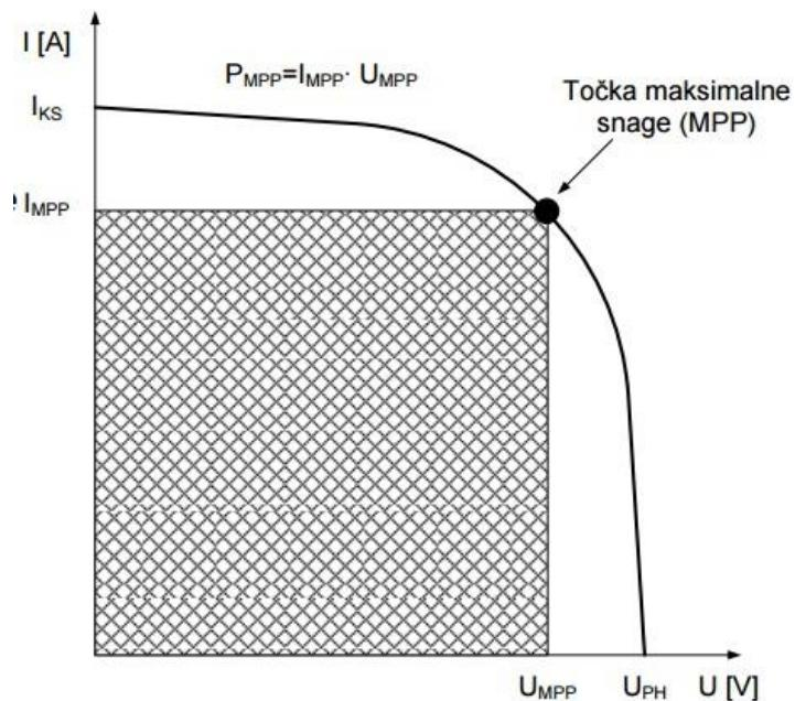
*Slika 2.5.: Strujno naponska karakteristika fotonaponskog modula [7]*
