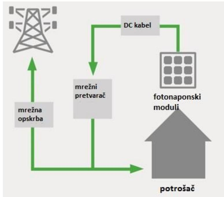
*Slika 2.7.: Shematski prikaz mrežnog fotonaponskog sustava [8]*
