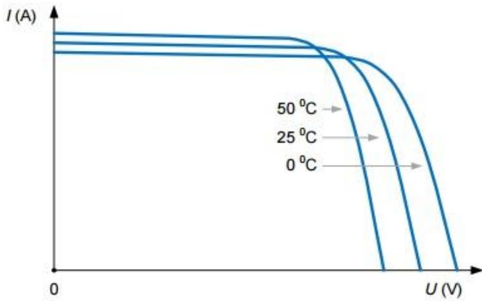
*Slika 2.6.: Ovisnost FN ćelije o temperaturi [7]*
