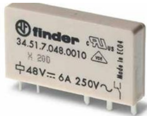
Sl. 4.11. Shema jednopolnog releja i realna izvedba releja [6].
