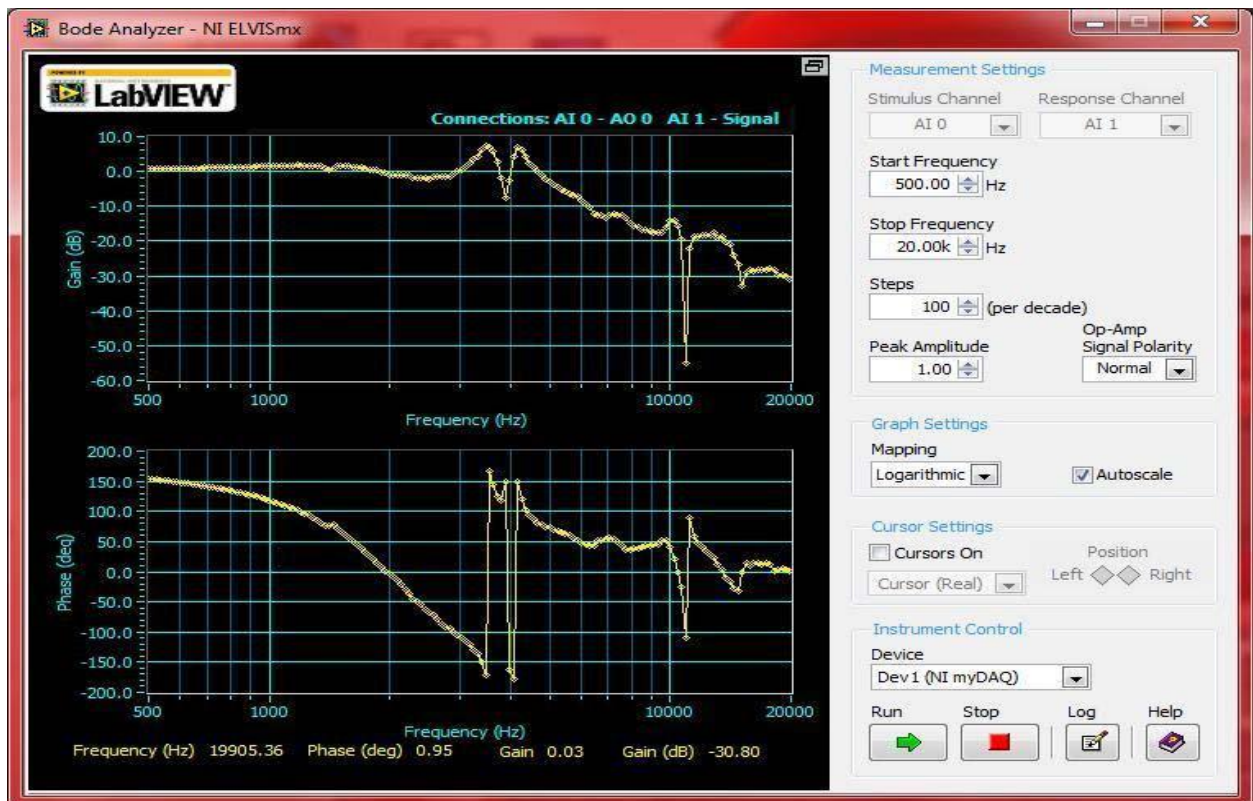
Slika 5.5. Grafički prikaz frekvencije uključenog zvučnika mjenenog mikrofonom prikazanog u proširenoj programskoj podršci NI LabVIEW [26].
