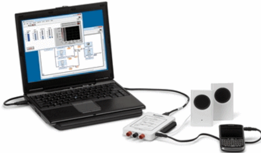
Slika 3.2. Prikaz izlaznog perifernog uređaja povezanog myDAQ platformom [7].
