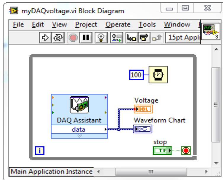
**Slika 4.6.** Prikaz primjera korištenja NI myDAQ u NI LabView (engl. Data In- DAQ Assistant lijevo) za unos naponskih podataka uz numeričkog pokazatelja na kojem su označene vrijednosti napona te grafičkog pokazatelja valnog oblika napona
