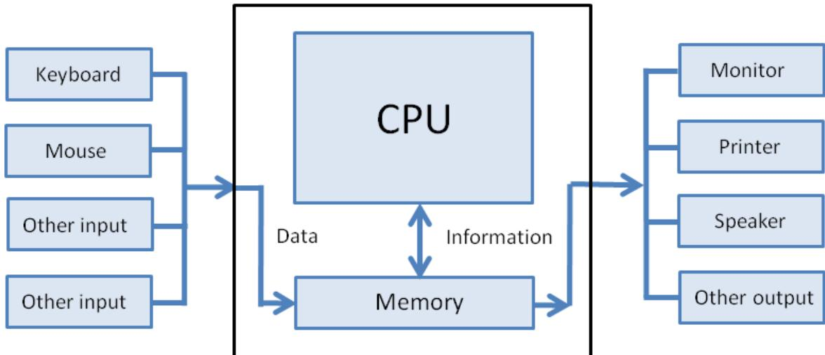
**Slika 3.3.** Prikaz ulazno / izlaznih uređaja [8].
