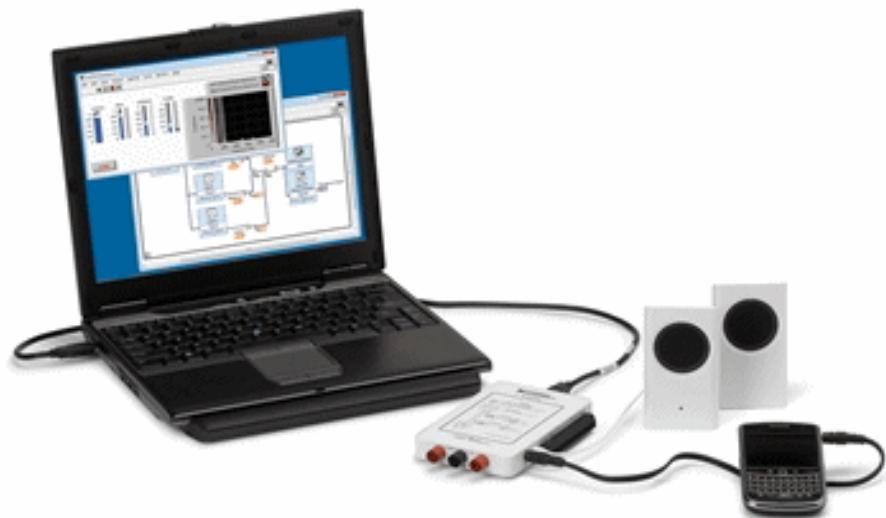
**Slika 3.2.** Prikaz izlaznog perifernog uređaja povezanog myDAQ platformom [7].
