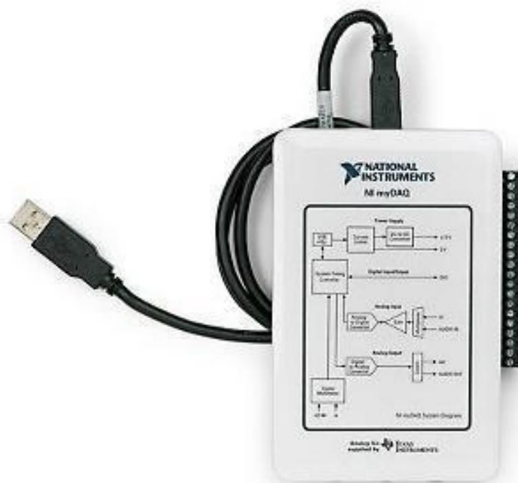
**Slika 2.1.** Prikaz myDAQ uređaja kompaktognog oblika [2].
