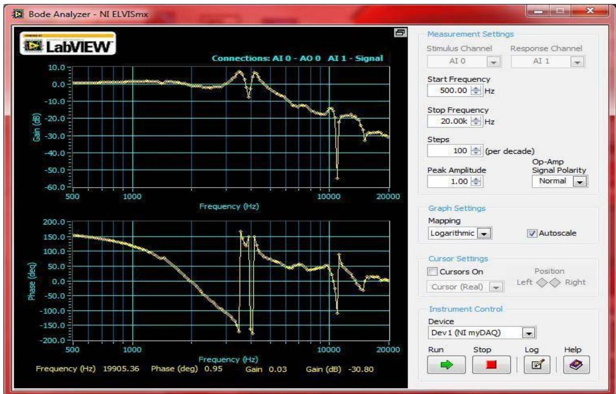
**Slika 5.5.** Grafički prikaz frekvencije uključenog zvučnika mјerenog mikrofonom prikazanog u proširenoj programskoj podršci NI LabVIEW [26].
