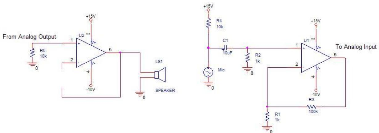
**Slika 5.4.** Prikaz spojenog kruga za mjerene preformansi zvučnika[26]
