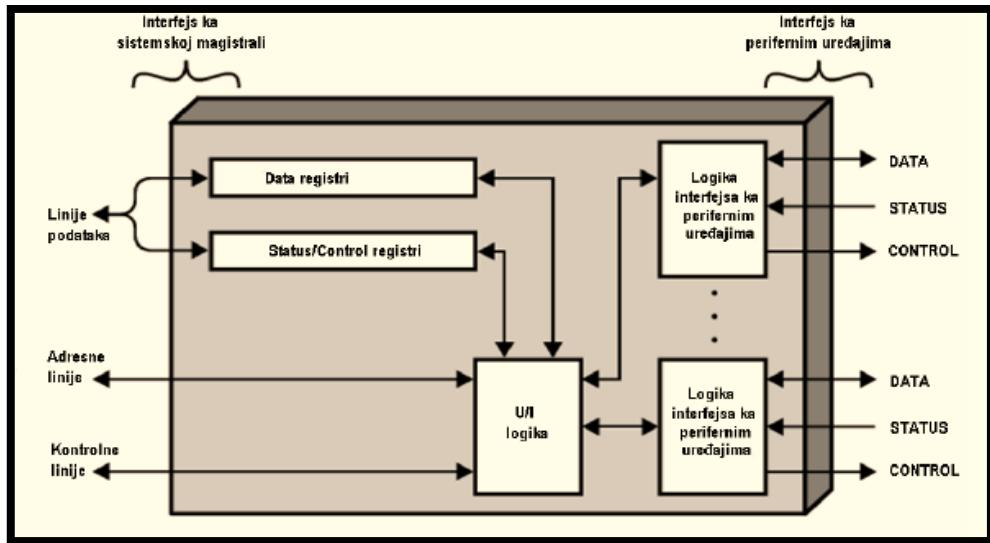
**Slika 3.6.** Blok dijagram ulazno/izlaznog prijenosnog modula [14].
