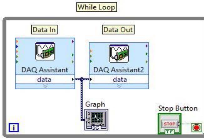
**Slika 4.3.** Prikaz primjera korištenja NI myDAQ u NI LabView za generiranje audio signala (engl. Data In- DAQ Assistant lijevo) i čitanje audio signala (engl. Data Out – DAQ Assistant2 desno) uz prikaz na grafičkom dijagramu, [23].
