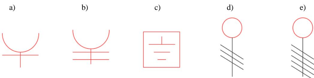
**Sl. 3.19.** Simboli za jednofaznu priključnicu (a), jednofaznu priključnicu sa poklopcom (b), kutiju za izjednačenje potencijala (c), jednofazni priključak (d) i trofazni priključak (e).
