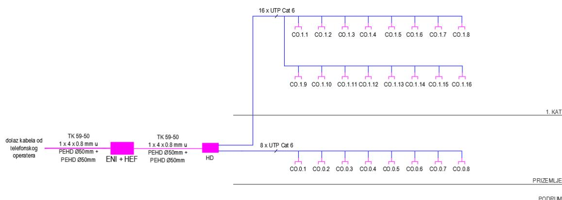
Sl. 3. 29. Primjer izrade sheme struktturnog kabliranja.
