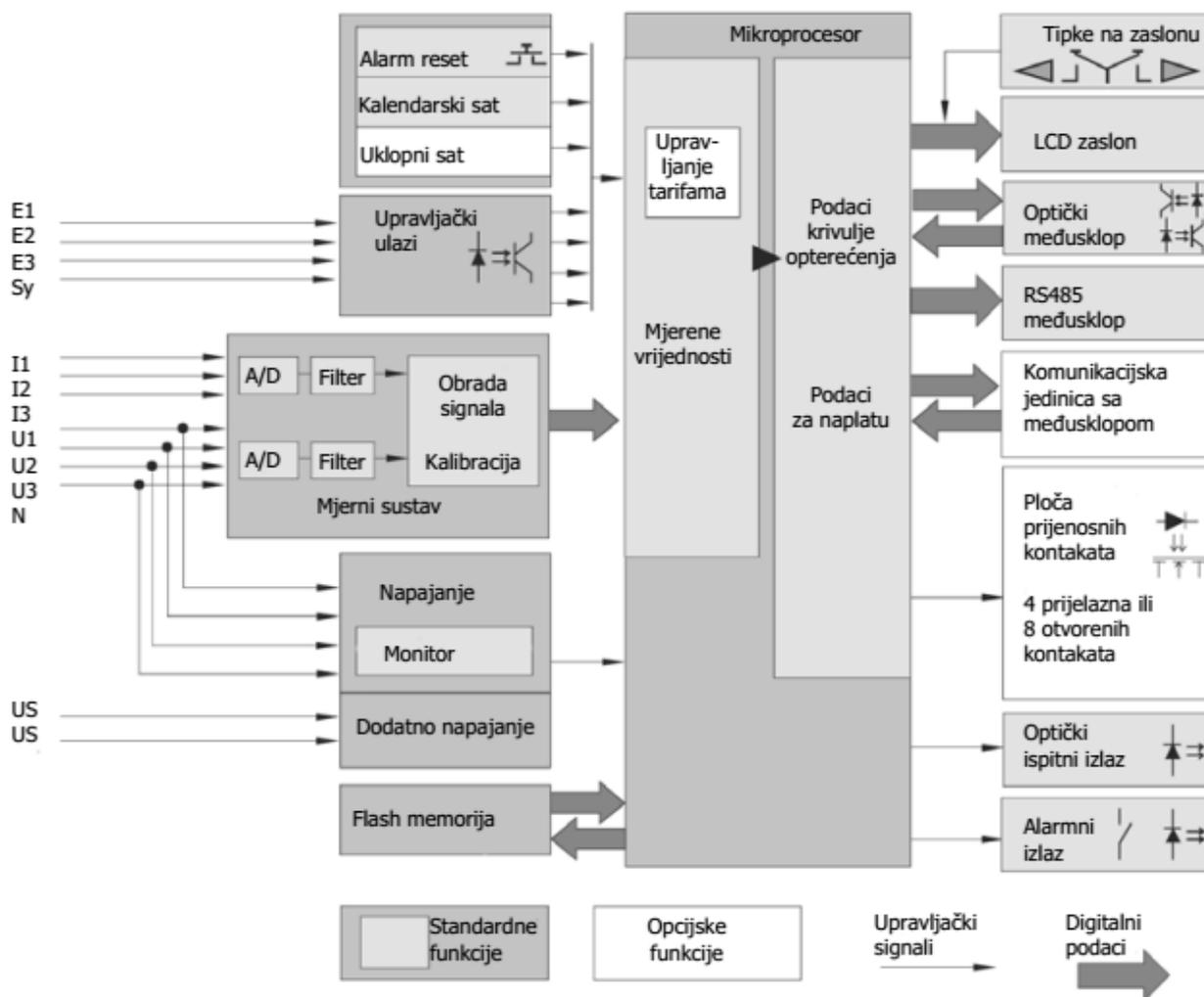
Sl. 4.8. Blok dijagram statičkog brojila električne energije [29]
