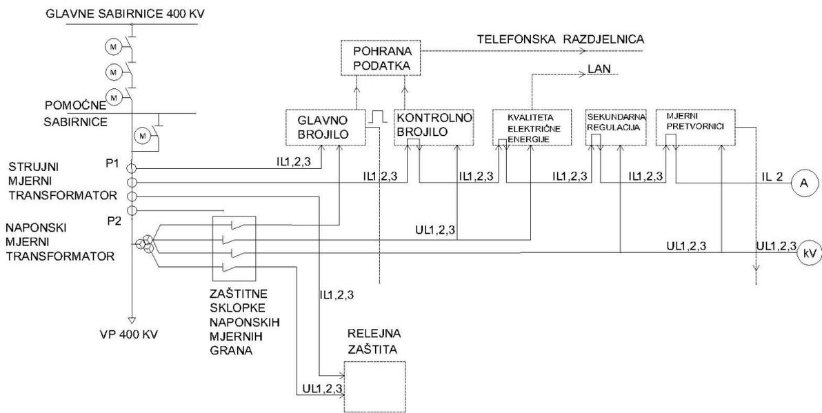
Sl.4.1. Električna shema sekundarnih mjernih grana
