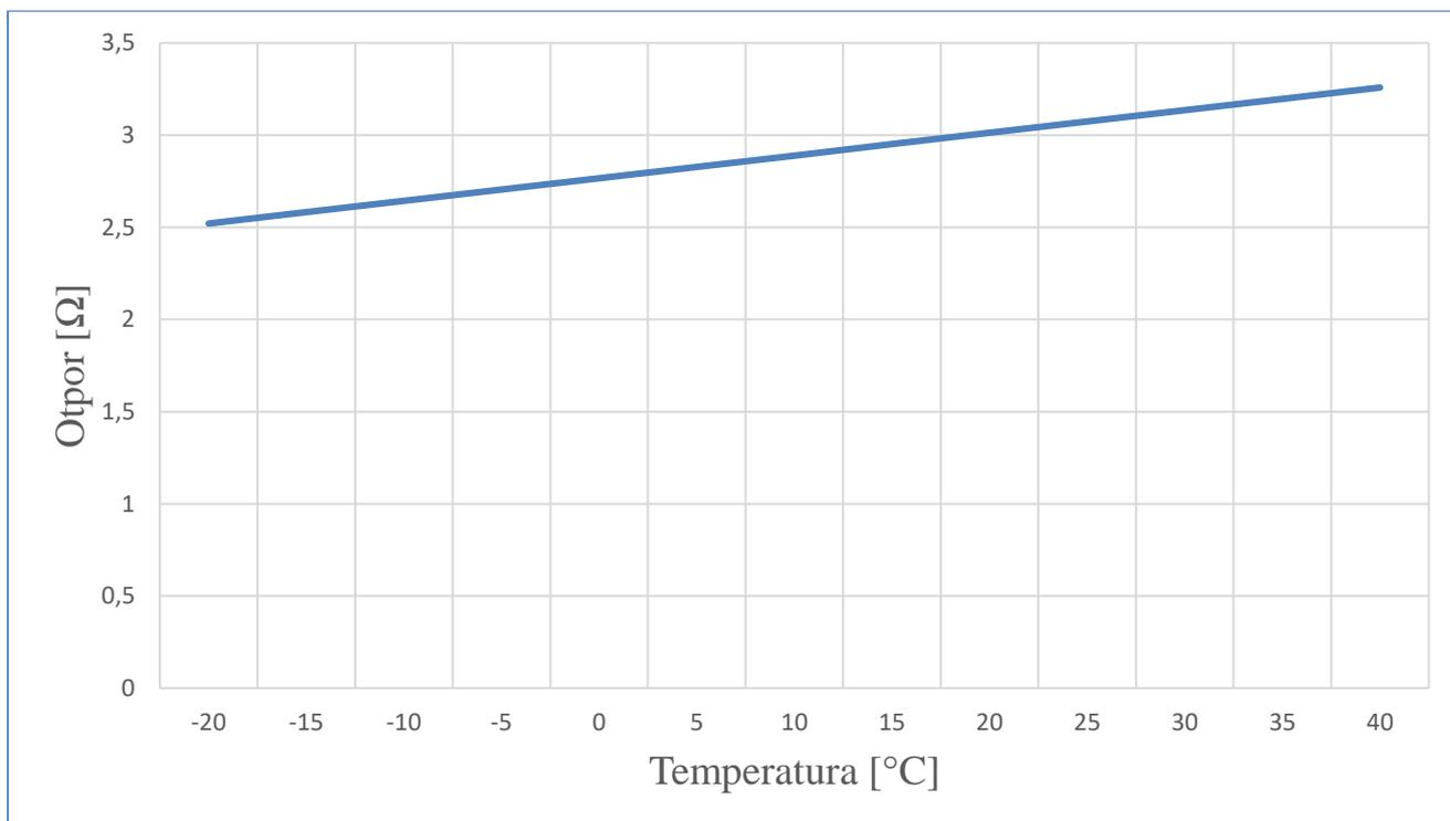
*Slika 7.13. Prikaz ovisnosti otpora vodiča o temperaturi okoline*
