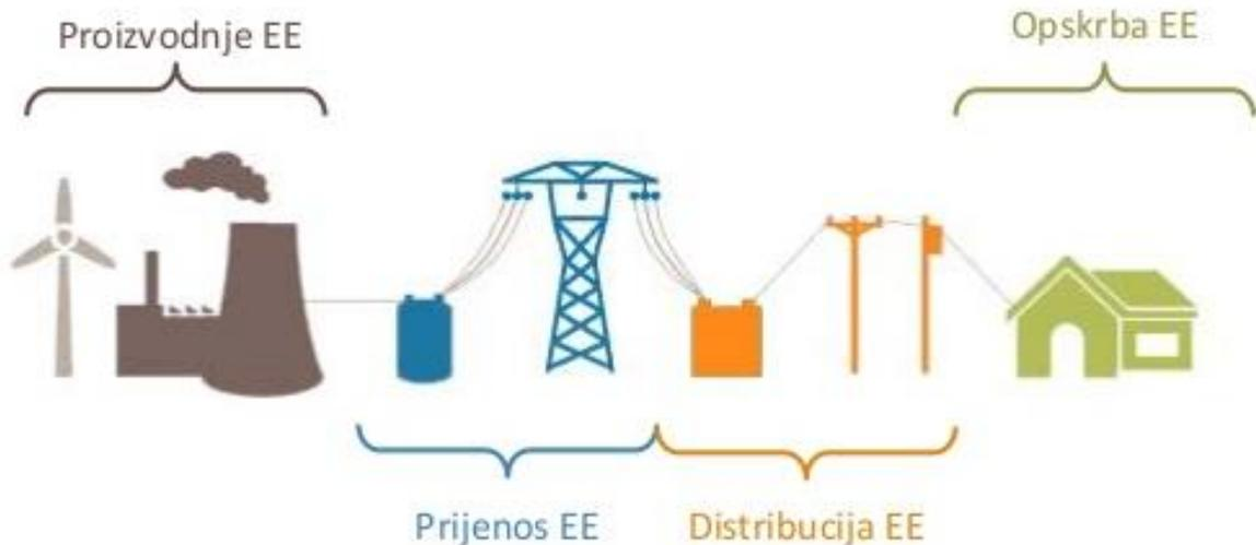
Sl. 2.1. Načelna shema elektroenergetskog sustava [2]
