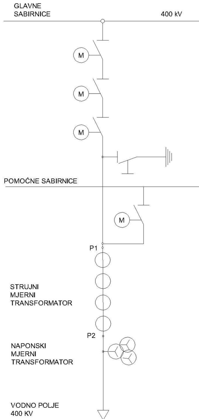
*Sl. 4.6. Jednopolna shema 400 kV vodnog polja*
