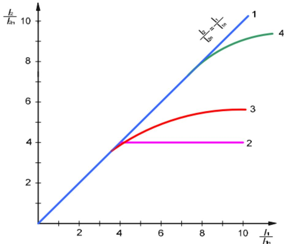
Sl. 4.2. Nadstrujna karakteristika strujnog transformatora za zaštitu i mjerenje
