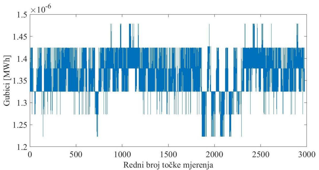
*Sl.7.3. Prikaz izračunatih poprečnih gubitaka prema gamma shemi*
