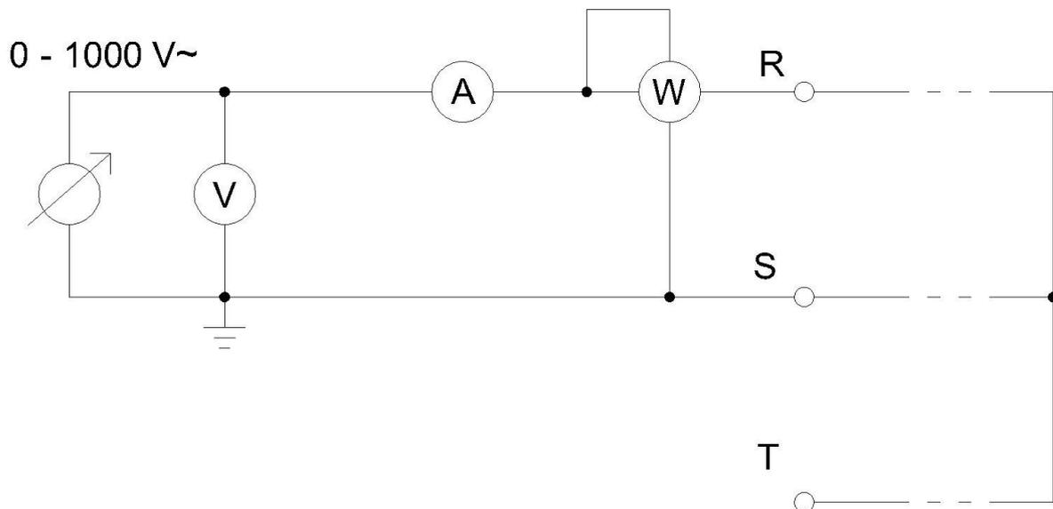
Sl. 3.3. Principijelna shema jednofaznog mjerenja direktnih parametara
