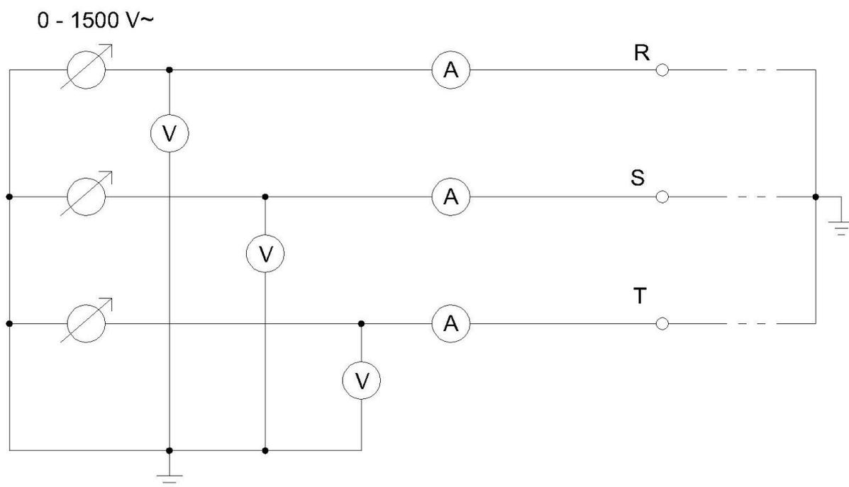
Sl. 3.3. Principijelna shema trofaznog mjerenja direktnih parametara
