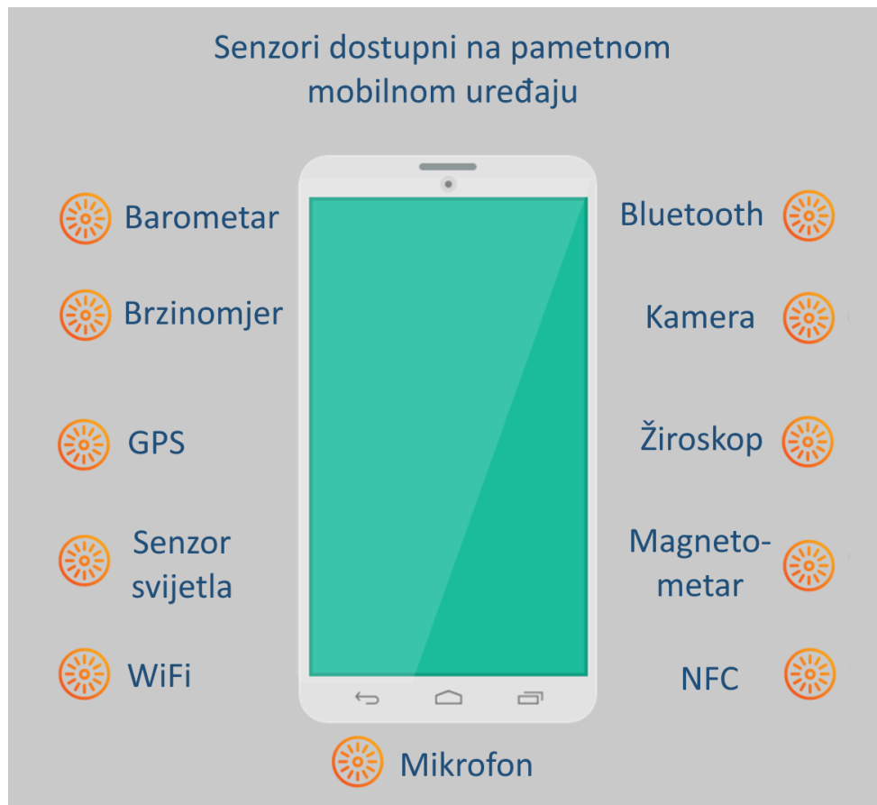
Slika 3.1. Senzori pametnih mobilnih uređaja
