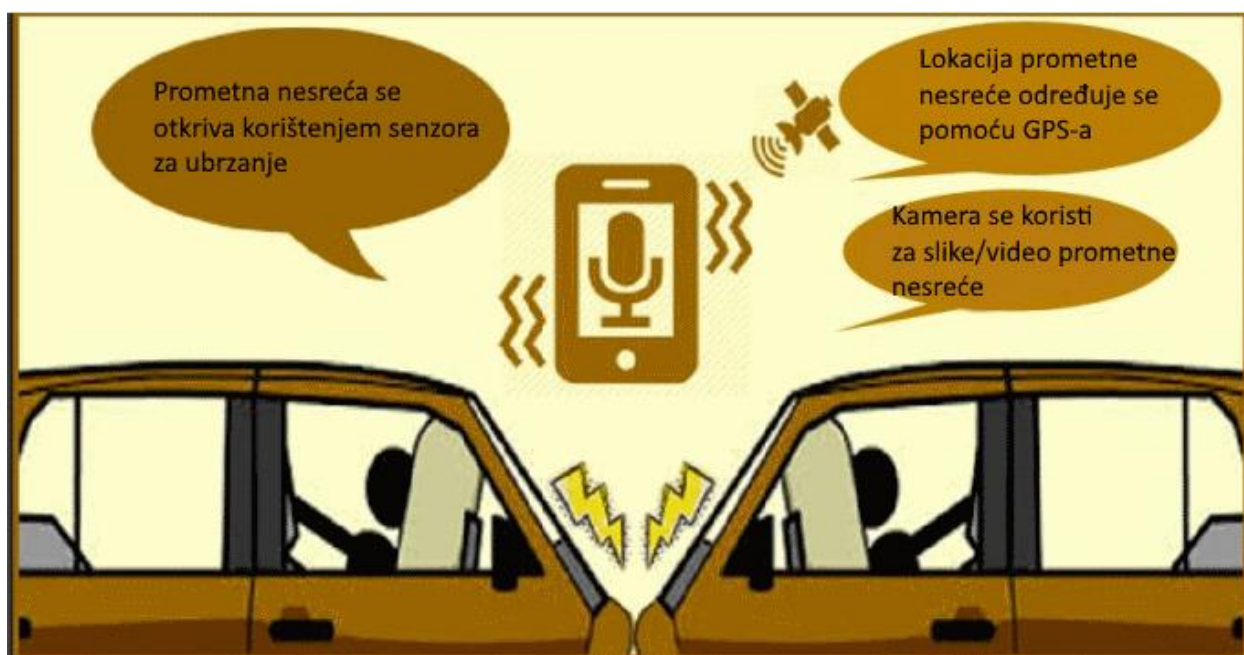
Slika 3.3. Detekcija prometne nesreće pomoću mobilnog uređaja
