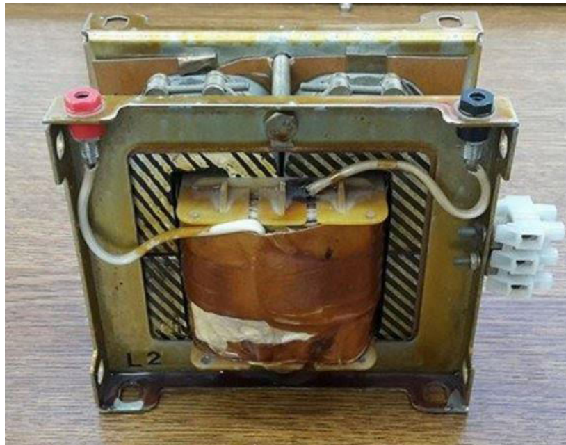
Slika 3.14. Prigušnica, R=2\Omega , L=330mH
