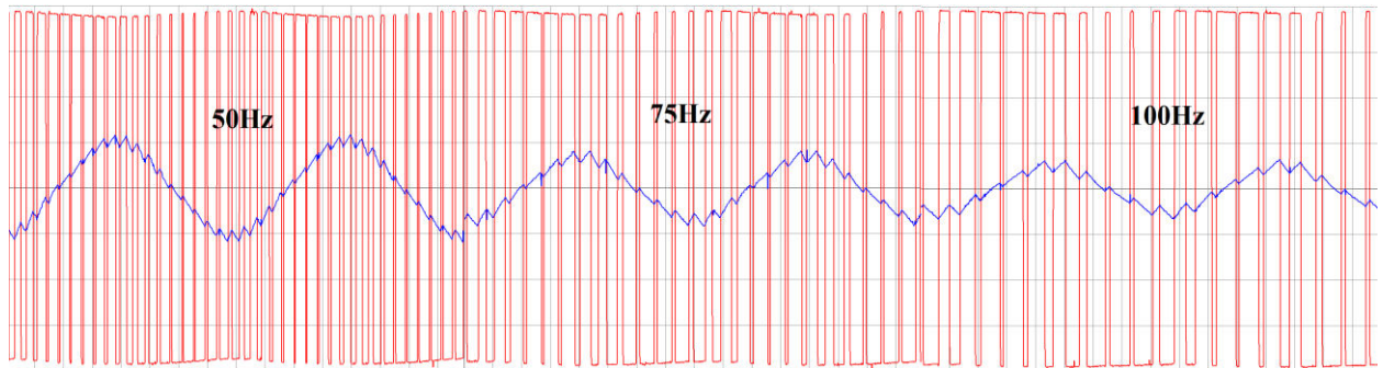
Slika 4.37. Valni oblici struje i napona sinusne modulacije pri nižoj sklopnoj frekvenciji
