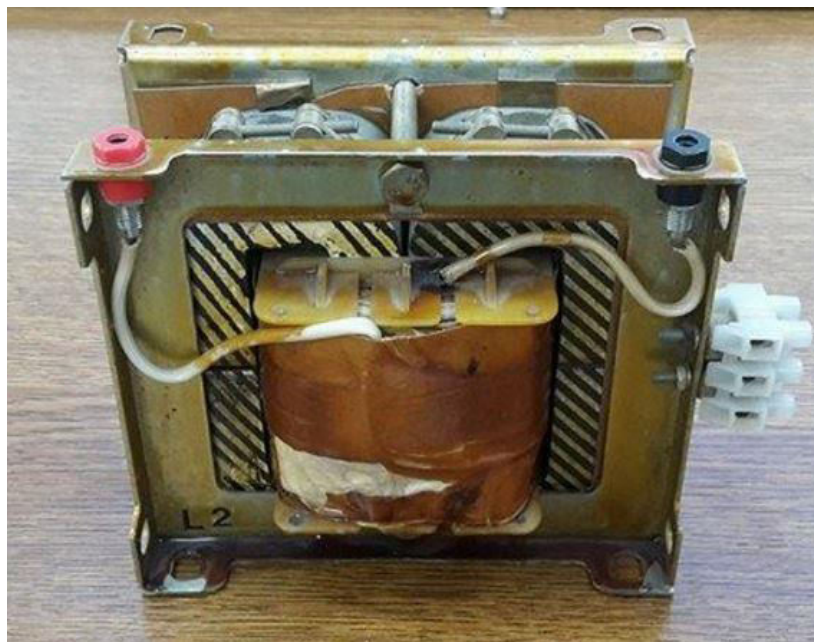
Slika 3.14. Prigušnica, R=2\Omega , L=330mH
