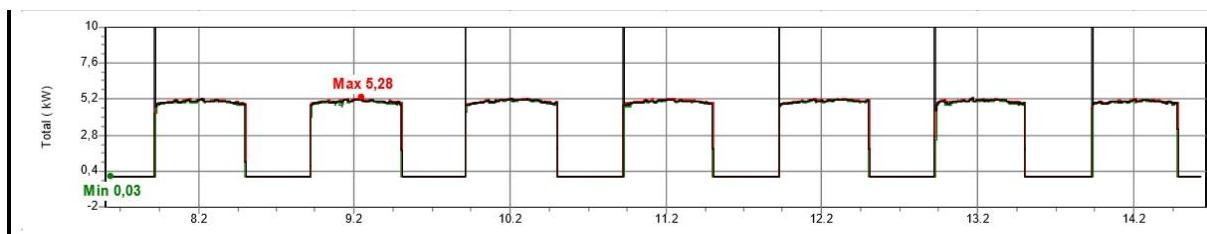
Slika 5.4. Graf ukupne snage za visokotlačnu natrijevu rasvjetu
