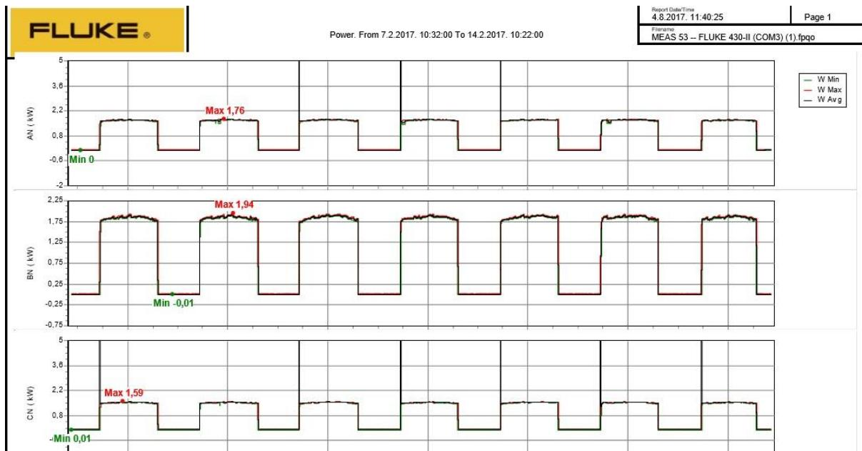
Slika 5.3. Graf snage po fazama visokotlačne natrijeve rasvjete
