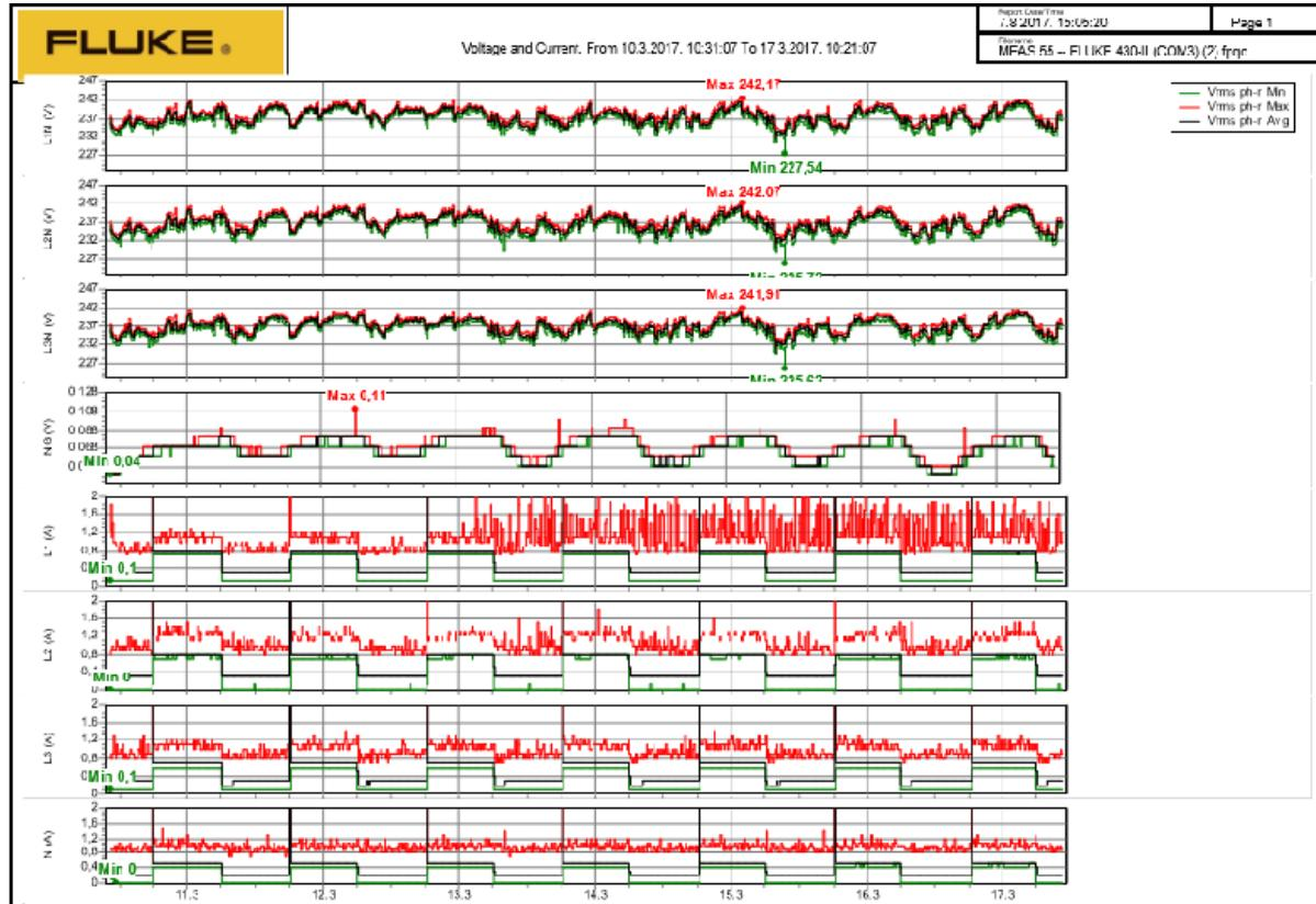
Slika 5.2. Grafovi struje i napona za LED rasvjetu
