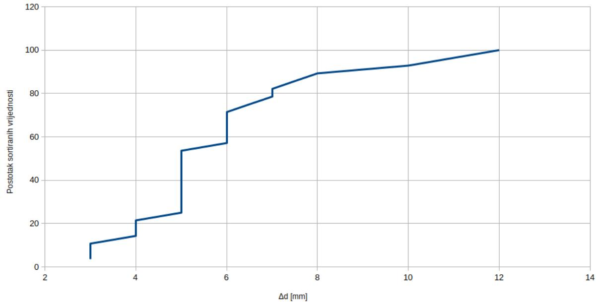
Slika 4.4.1: Odstupanje alata robotskog manipulatora od središta markera za kalibraciju s 50 točaka
