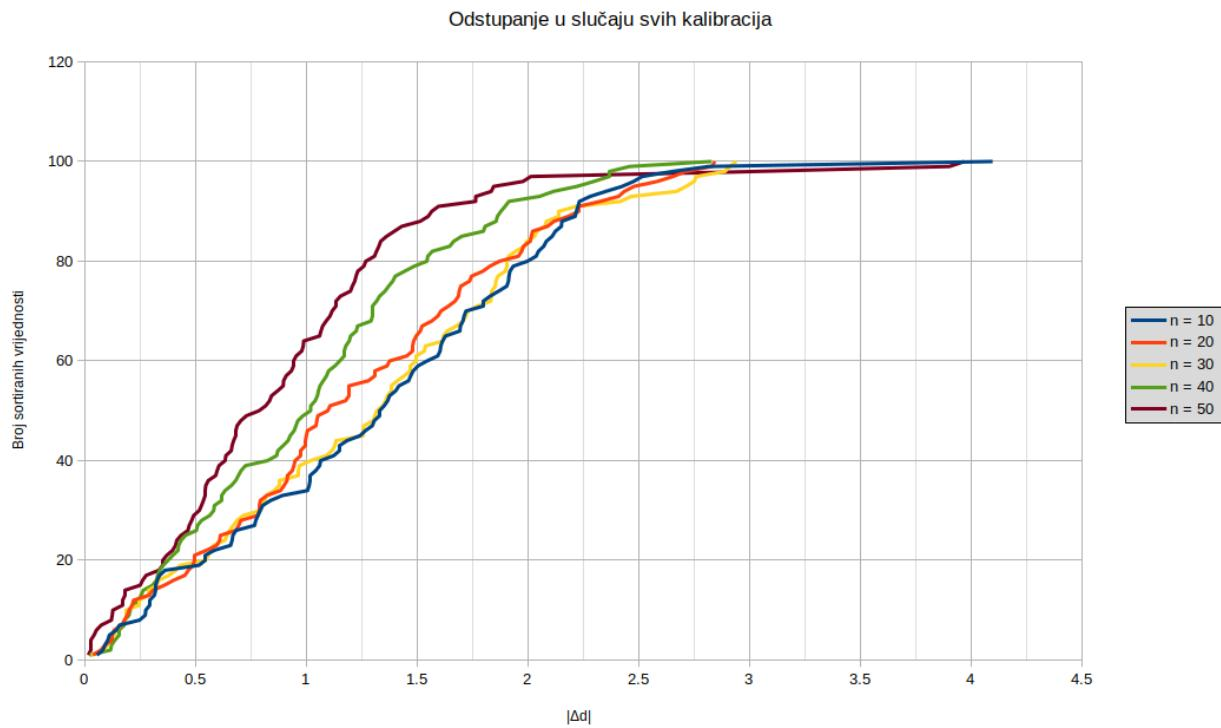
Slika 4.3.12: Prikaz sortiranih apsolutnih razlika udaljenosti parova koordinata od ishodišta koordinatnog sustava robota za sve kalibracije
