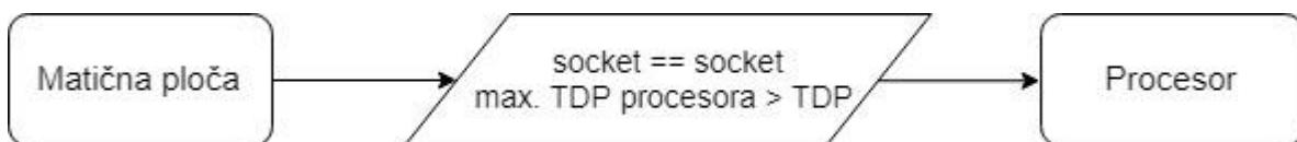
Slika 3.3. Uvjet kompatibilnosti matične ploče i procesora
