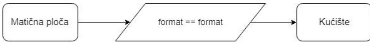
Slika 3.4. Uvjet kompatibilnosti matične ploče i kućišta
