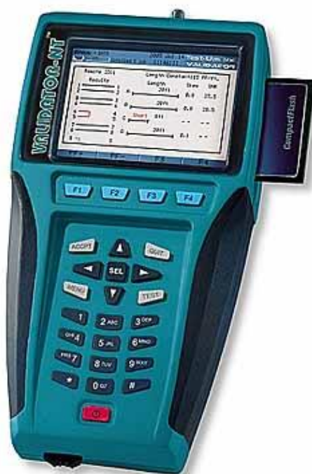
Slika 4.2.30. JDSU Validator NT955 [24]
