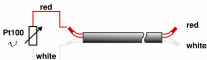
Slika 2.8. Način spajanja PT 100 sonde
