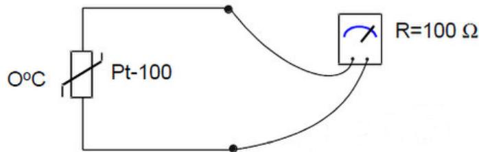
**Slika 2.5.** Otpor PT 100 sonde pri temperaturi  $0\text{ }^{\circ}\text{C}$
