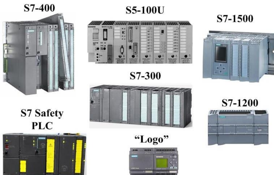
Slika 3.1 Razne serije Siemens PLC-a [3]
