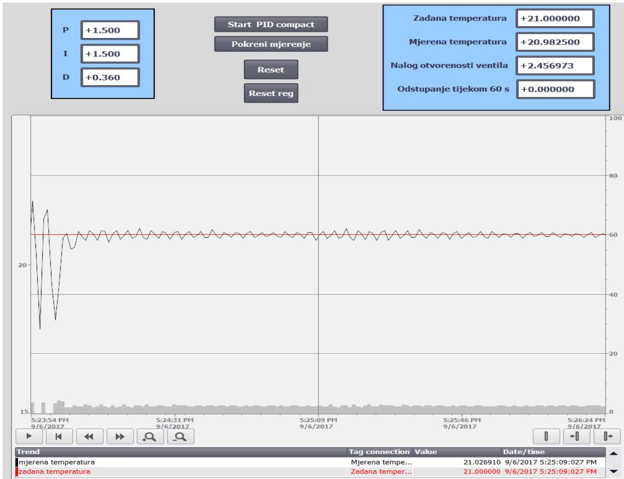
**Slika 5.3.** Odziv simuliranog sustava sa izračunatim parametrima
