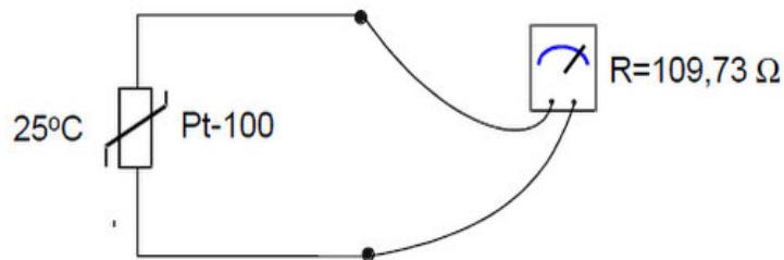
**Slika 2.6.** Otpor PT 100 sonde pri temperaturi  $25\text{ }^{\circ}\text{C}$
