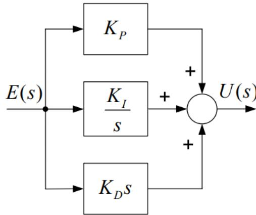
**Slika 4.2.** Idealni PID regulator – paralelna izvedba [9]
