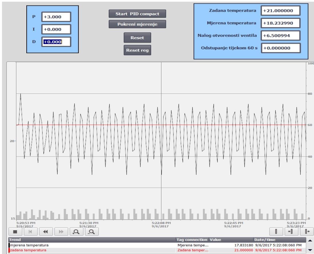
**Slika 5.2.** Simulacija dovođenja sustava na rub stabilnosti
