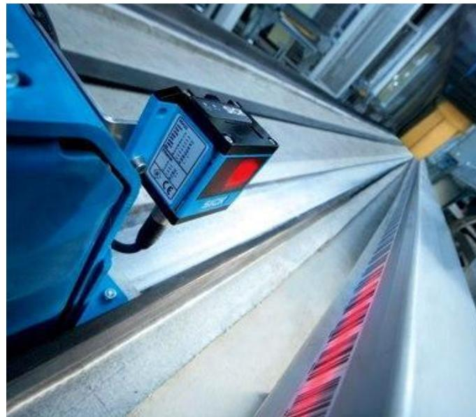
*Slika 4.38. Fotoelektrični senzor položaja kabine [12]*
