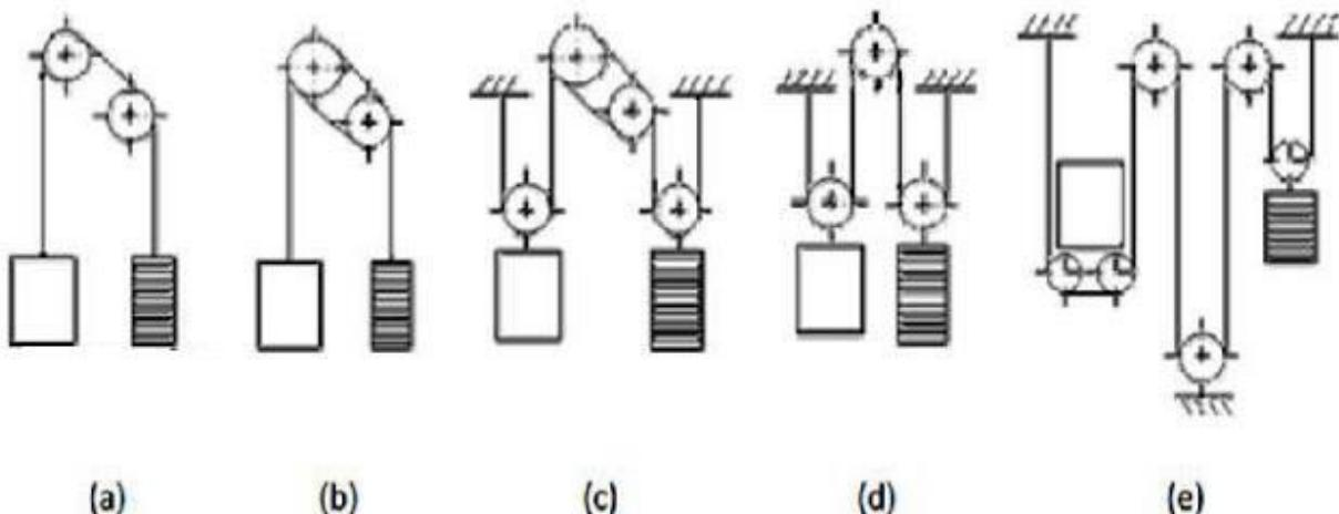
*Slika 4.31. Način povezivanja kabine i protuutega [3]*
