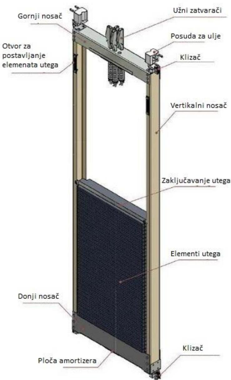
*Slika 4.29. Komponente protuutega [11]*
