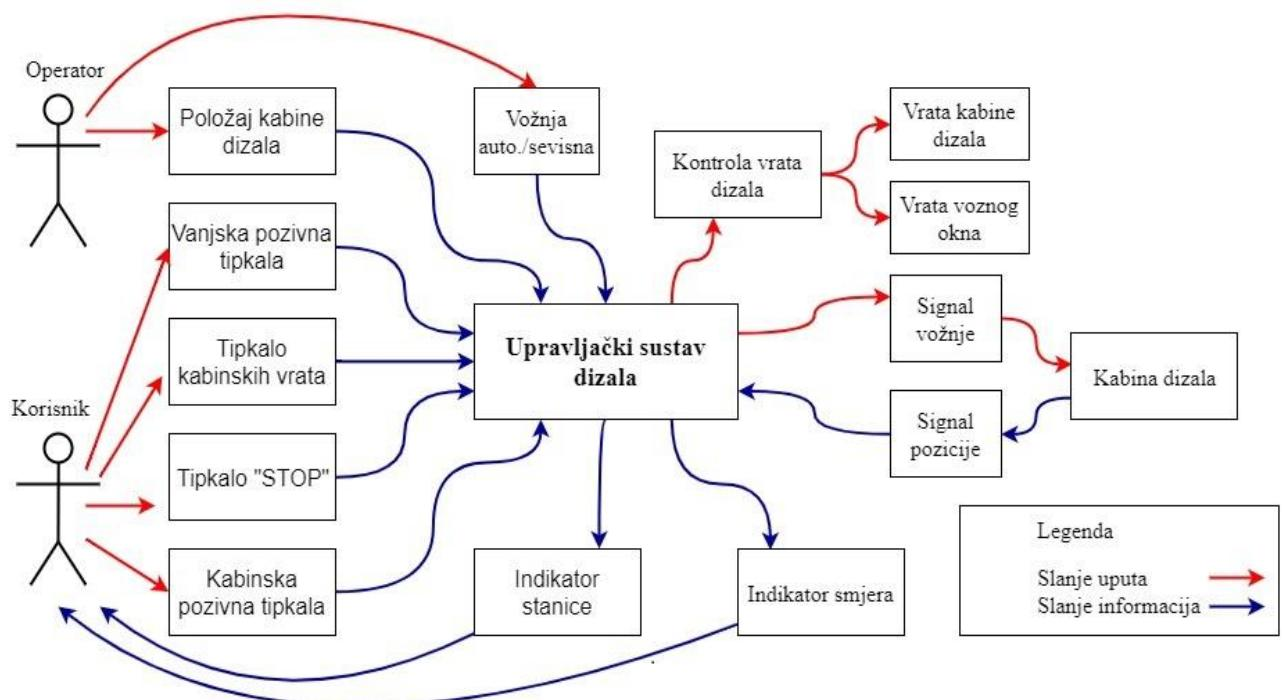
Slika 4.37. Jednostavni ulazi i izlazi upravljačkog sustava dizala [12]
