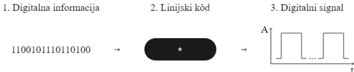
Slika 2.1. Uloga linijskog koda u komunikacijskom kanalu
