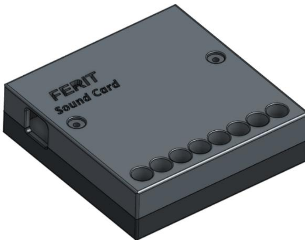
Sl. 3.15. Gotov model zaštitnog kućišta
