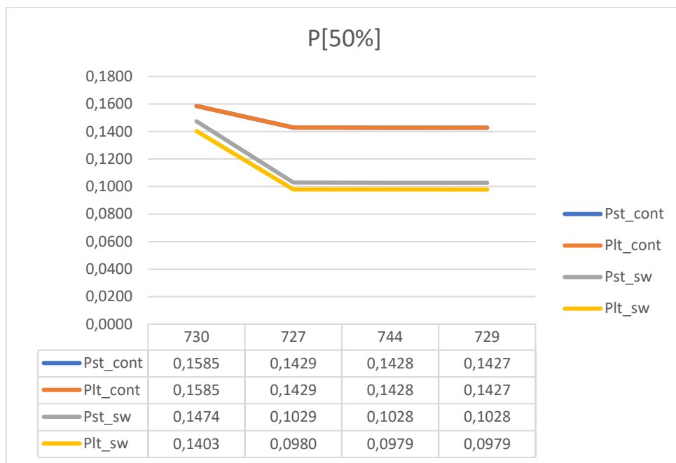
Graf 5.42. Prikaz promjene faktora treperenja na karakterističnim sabirnicama za izlaznu snagu agregata iznosa 50% ukupnog opterećenja
