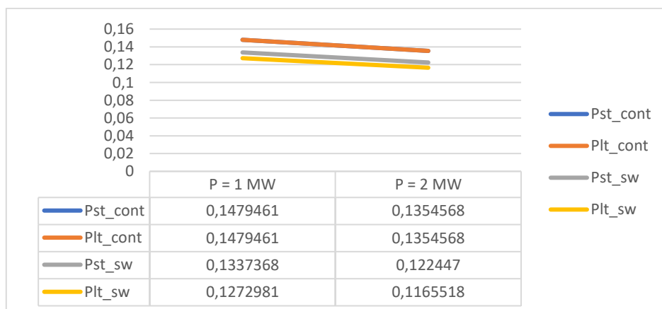
Graf 5.74. Prikaz promjene na faktora treperenja na sabirnici promjenjive radne snage
