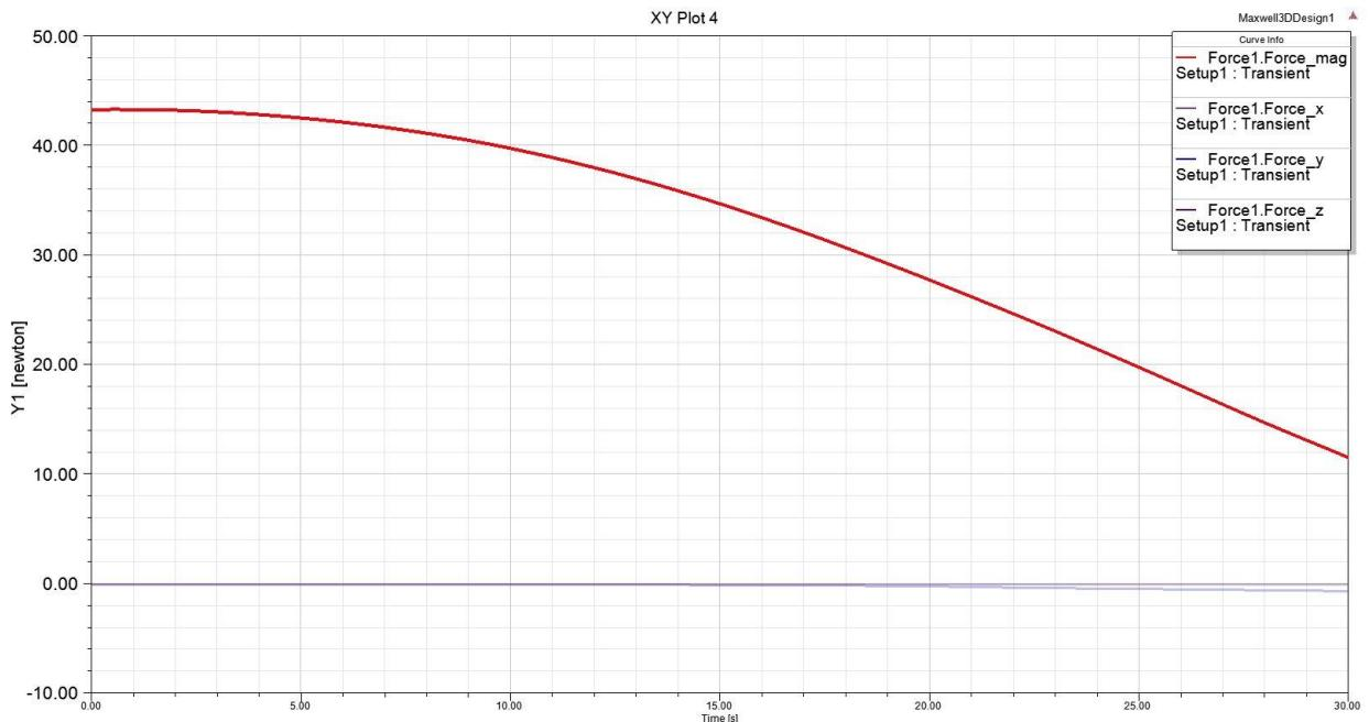
**Slika 4.3.4.** Prikaz magnetske sile za pomaknuti rotor
