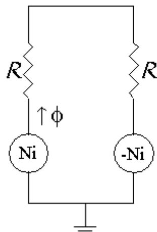
**Slika 2.3.1.** Magnetski krug zatvoren kroz dva zuba statora [3]
