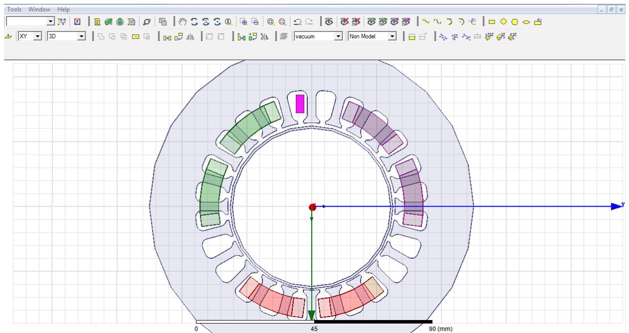
**Slika 3.2.1.** Pozicioniranje magnetskog ležaja pri izradi pomoćnih zavojnica
