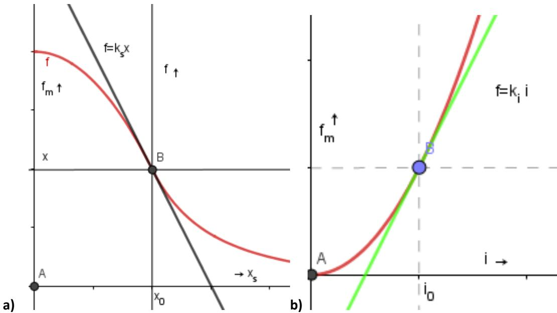
Slika 2.4.2. Prikaz ovisnosti magnetske sile o pomaku (a) i jačini struje (b)
