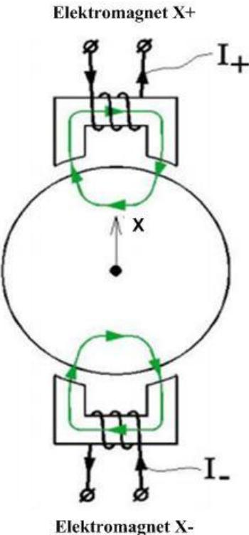
**Slika 2.4.1.** Rotor pokretan dvjema zavojnicama [4]
