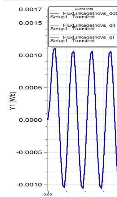
**Slika 4.2.2.** Prikaz magnetskog toka za nultu poziciju rotora
