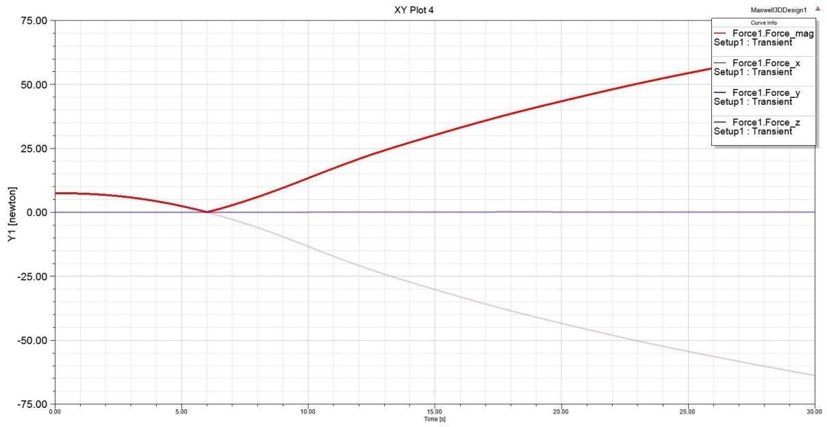
**Slika 4.3.2.** Prikaz magnetske sile za nultu poziciju rotora
