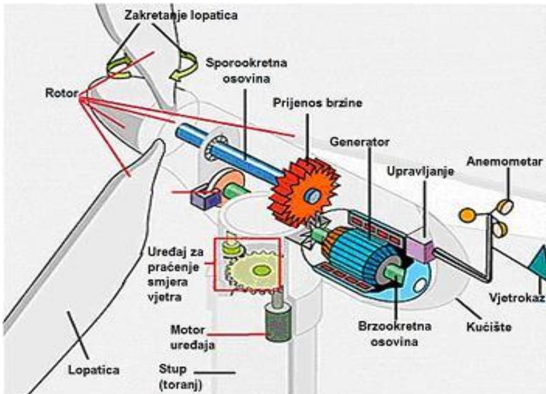
**Slika 2.7.** Osnovni dijelovi vjetroagregata (Slika preuzeta iz [7])
