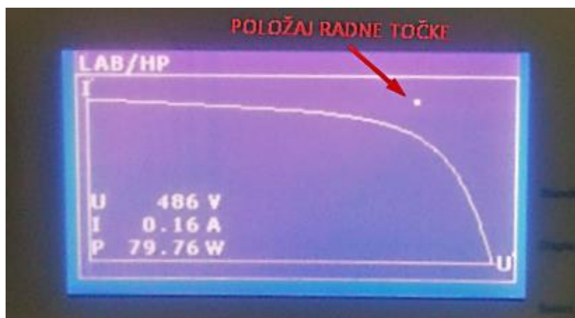
Slika 4.2. Trenutak položaja RT van karakteristike
