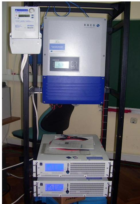
Slika 2.1. Emulator fotonaponskog sustava
