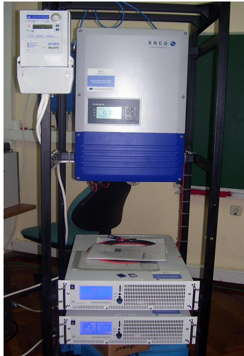
Slika 2.1. Emulator fotonaponskog sustava
