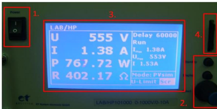
**Slika 2.7.** Prikaz prednje upravljačke ploče istosmjernog izvora
