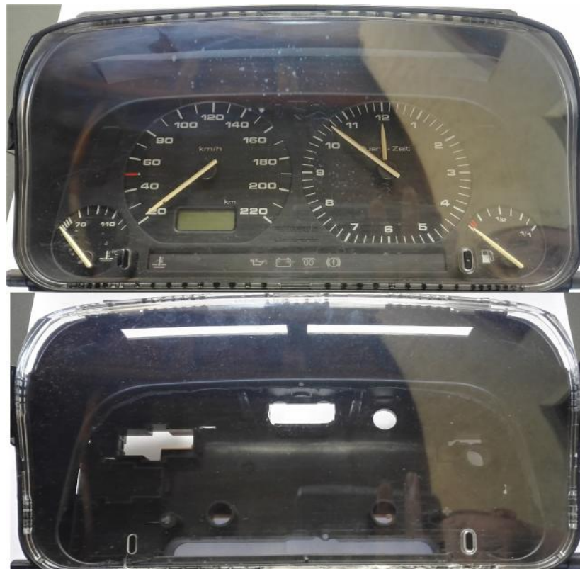
SI 3.12. Originalna kontrolna ploča prije i poslije izbacivanja elektronike
