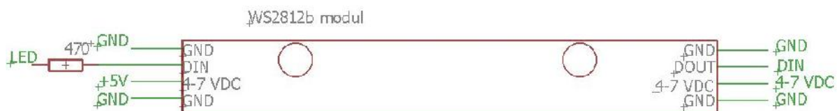
SI 3.9. Shema spajanja LED modula
