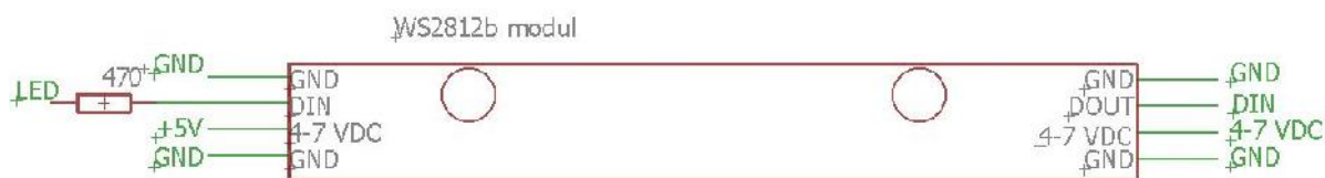
SI 3.9. Shema spajanja LED modula
