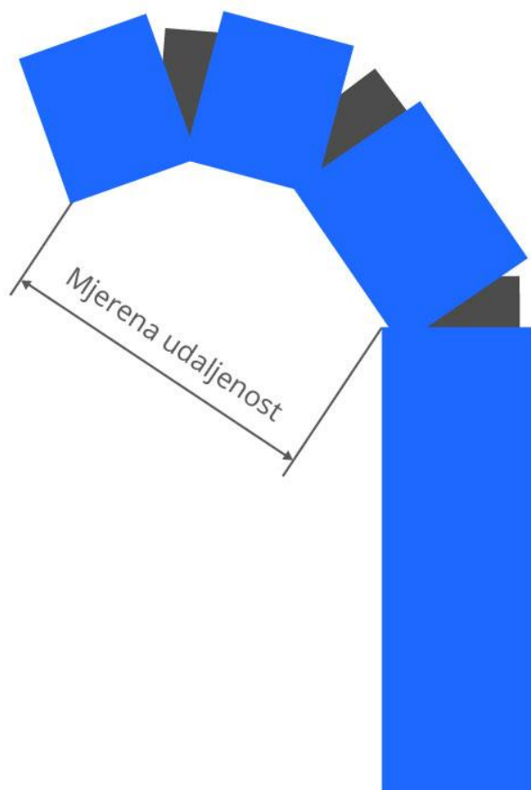
Slika 4.1. Mjerena udaljenost na mehatroničkoj šaci
